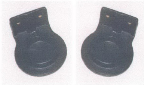
Şekil 5.13 Helezon yay şasi bağlantı braketi
