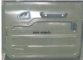
Şekil5.62 GTD Model kapı kuşağı sağ
