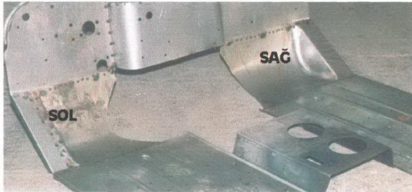
Şekil 5.77 Sol ve sağ çökertme sacı
