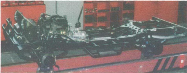
Şekil 5.41 Şase yanağı sağ ve sol
