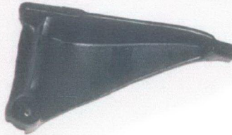
Şekil 5.21 Sağ motor kulak blok bağlantı braket
