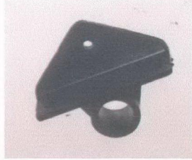
Şekil 5.14 Arka makas hareketli küpe bağlantı braketi
