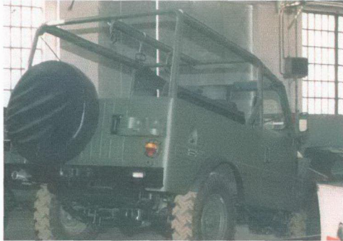
Şekil 5.72 GTD Model araçta rollbar ve destek boruları
