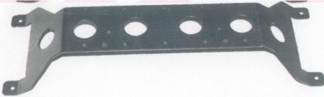
Şekil 5.44 Ön travers alt tablası
