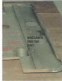
Şekil 5.82 Arka taban alt bağlantı destek sacı
