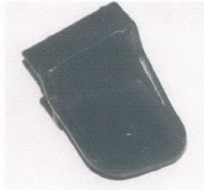
Şekil 5.6 Sol motor kulağı şase bağlantı braketi
