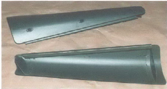
Şekil 5.73 Ön cam çerçevesi sağ ve sol rollbar bağlantı sacı
