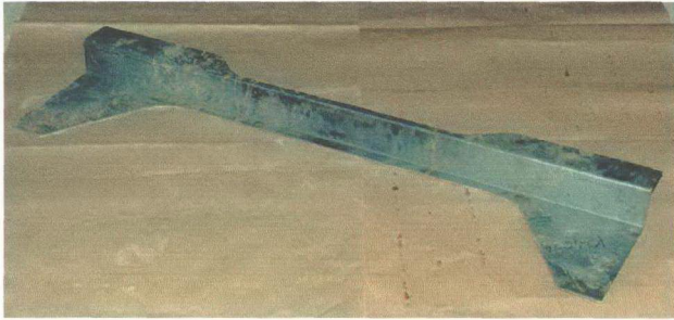
Şekil 5.83 Arka taban rollbar destek sacı
