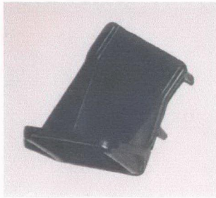
Şekil 5.5 Sağ motor kulağı şase bağlantı braketi
