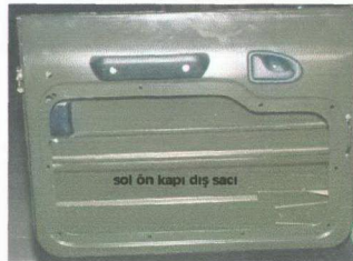
Şekil 5.60 GTD Model sol ön kapı dış sacı
