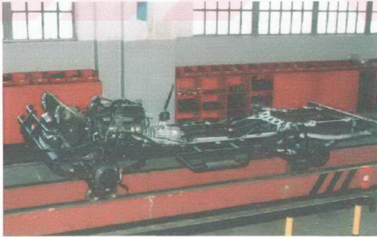
Şekil 3.10 Şasi ve şasi üzerine tespit edilen parçaların görünümü
