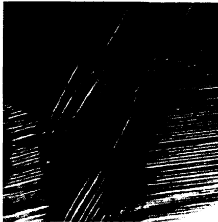
Şekil 4.5 Au-Cd, In-Th, Mn-Au ve Mn-Cu alaışımındakine benzer, Au-34Cd alaışımındaki ikizlenmiş martenzitik yapının parlatılarak nomarski interference contrast mikroskopundaki görüntüsü (400X) (Hodgson ve Biermann, 1993)
