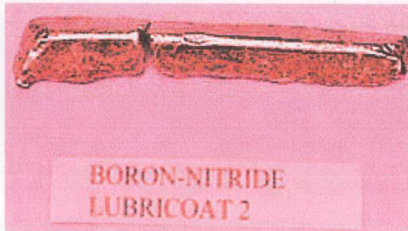
Şekil 6.8 Lubriccoat kalıp ayırıcısına şaloma alevi tutulmuş döküm parçasının görünümü.
