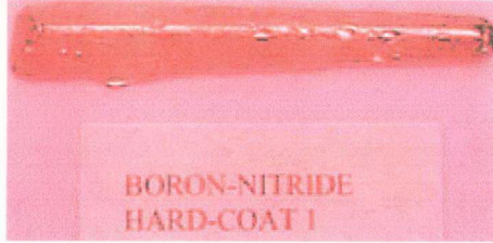
Şekil 6.5 Hard-Coat kalıp ayırıcısına şaloma alevi tutulmamış döküm parçasının görünümü.
