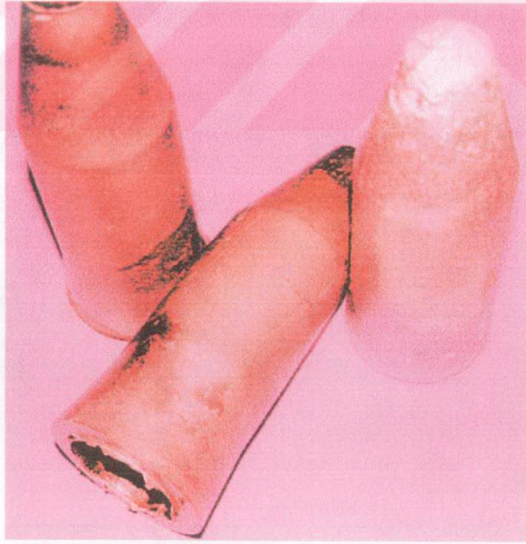
Şekil 6.15 Sıkıştırılmalı döküm yöntemiyle üretilmiş basınç görmüş ve basınç görmemiş parçalar.
