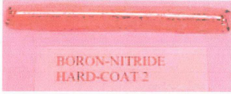
Şekil 6.6 Hard-Coat kalıp ayırıcısına şaloma alevi tutulmuş döküm parçasının görünümü.
