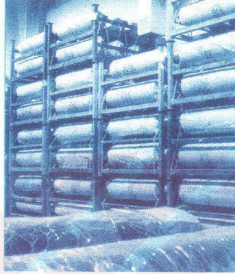
Şekil 5.3 Olgunlaştırma askılarında SMC ruloları (Inoplast, 1998)
