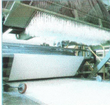
Şekil 5.2 Bilgisayar kontrollü doyurma yöntemi; reçine tabakaları arasındaki cam fiberin görünümü (Inoplast, 1998)
