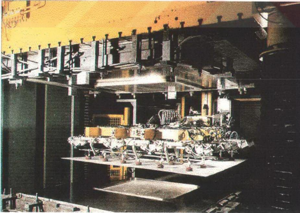
Şekil 6.14 SMC parçasının kalıptan çıkarılışı (Inoplast, 1998)
