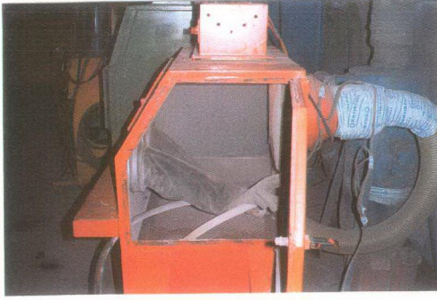
Şekil 5.2 Kum püskürtme makinesi (Alüminyum plakalar burada kumlama işlemine tabi tutuldu)
