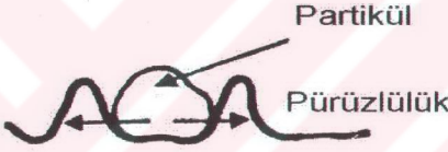
Şekil 3.3 Toz partikülün pürüzlülük üzerine etkisi (2): Toz partikül düz yüzeyde; Mekanik bağlanma daha iyi (Wigren, 1992)
