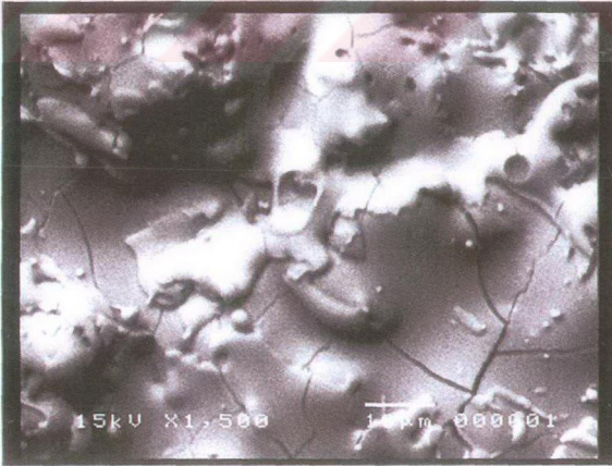
Şekil 6.3 Magnezyum-oksit stabilizeli zirkonyumoksitin 1500X SEM görünüşü(astarsız)
