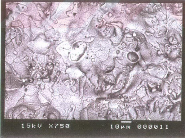
Şekil 6.42 %97Al 2 O 3 -%3TiO 2 750X SEM görünüşü
