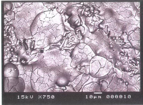
Şekil 6.37 %60Al 2 O 3 -%40 TiO 2 (astarsız) 750X SEM görünüşü(1)
