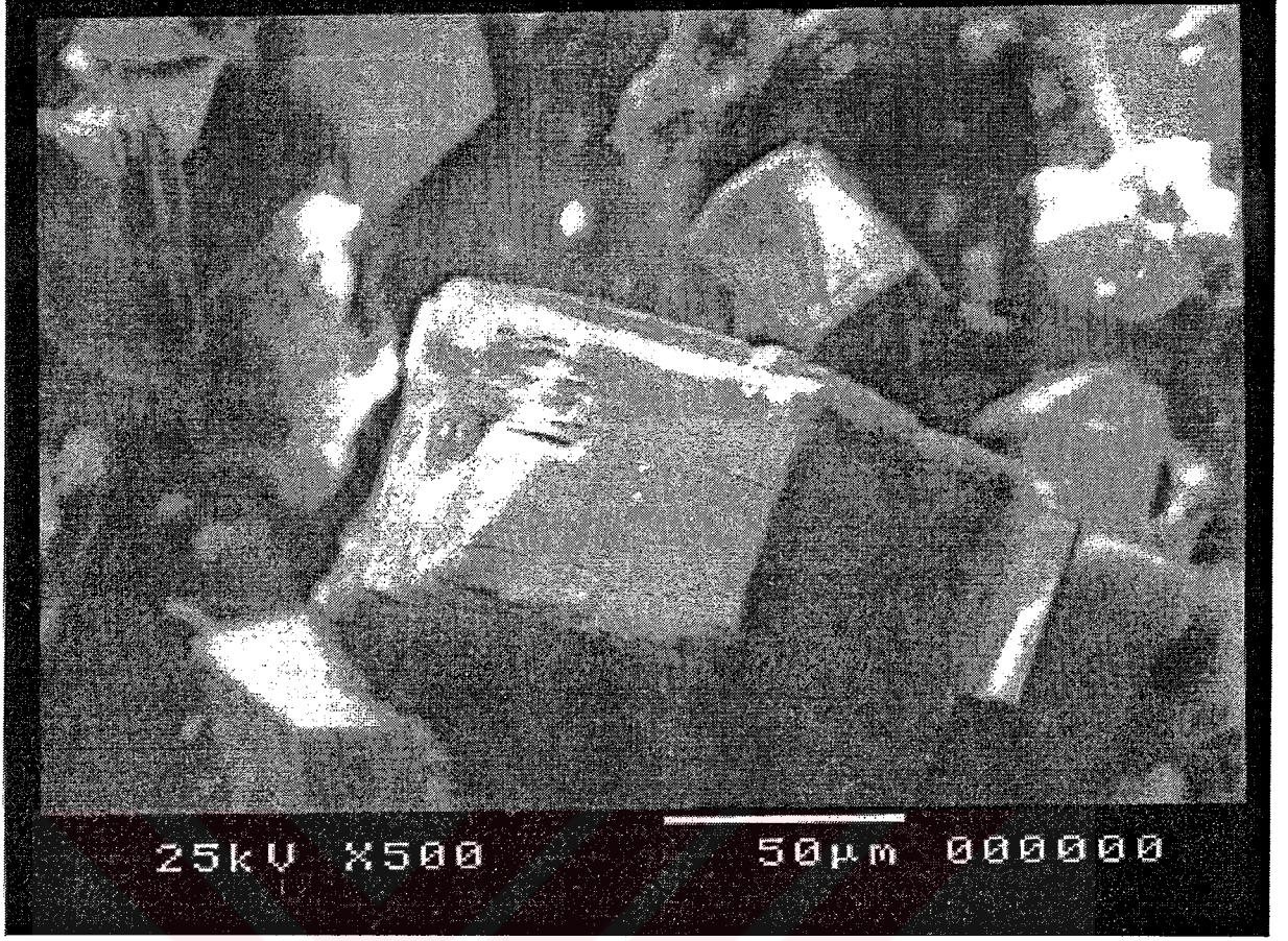
Şekil 5.12 (+0,05 - 0,1) boyutunda, asit aktivasyonu yapılmadan 390 °C 'de 1 saat ısıtılma aktivasyona tabi tutulmuş numunenin, SEM 'deki x500 büyütmedeki görüntüsü.
