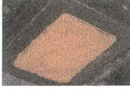
Şekil 6.5 Vulkanizasyon işlemine hazır kalıp (World Gold Council, 1995)
