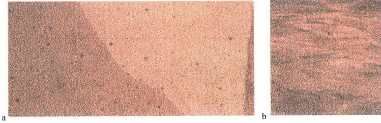
Şekil 5.20 21 ayar kırmızı altın alaşımın (a) döküm yapısı; (b) %70 oranında haddelenerek soğuk işlenmiş mikro yapısı (Forschungsinstitut für Edelmetalle und Metallchemie, 1996c)
