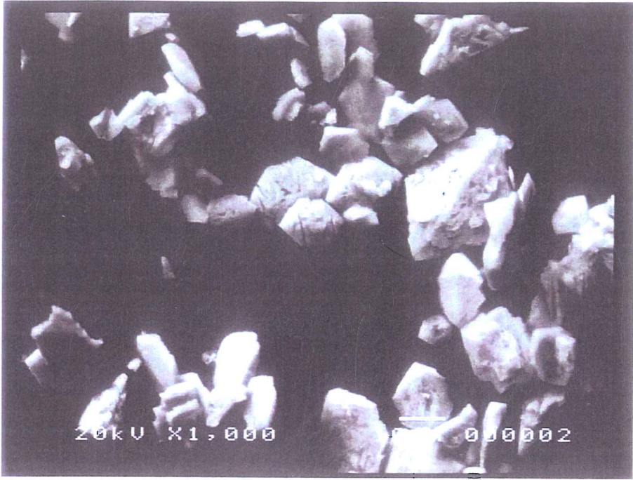
Şekil 7.5 Ultrasonik yöntemle üretilen çinko okzalat dihidratın SEM fotoğrafı
