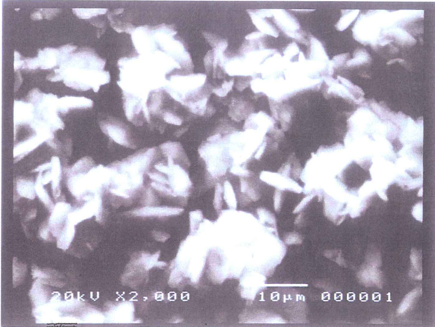
Şekil 7.4 Mekanik yöntemle üretilen çinko okzalat dihidratın farklı büyütmedeki SEM fotoğrafı
