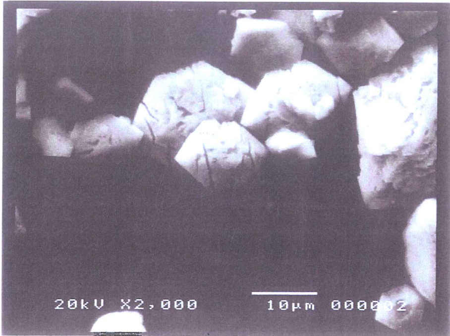
Şekil 7.6 Ultrasonik yöntemle üretilen çinko okzalat dihidratın farklı büyütmedeki SEM fotoğrafı
