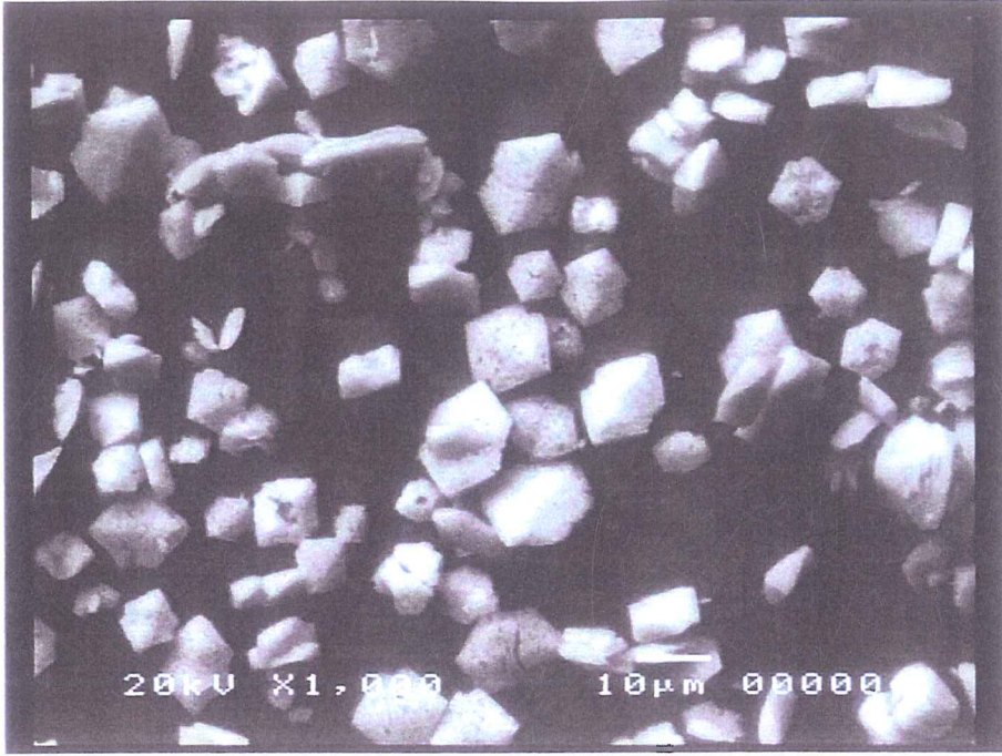
Şekil 7.17 Ultrasonik yöntemle üretilen çinko okside ait SEM fotoğrafı
