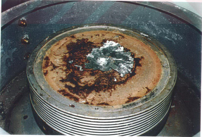
Şekil 4.15 Karma kalıbın dökümden sonraki resmi.
