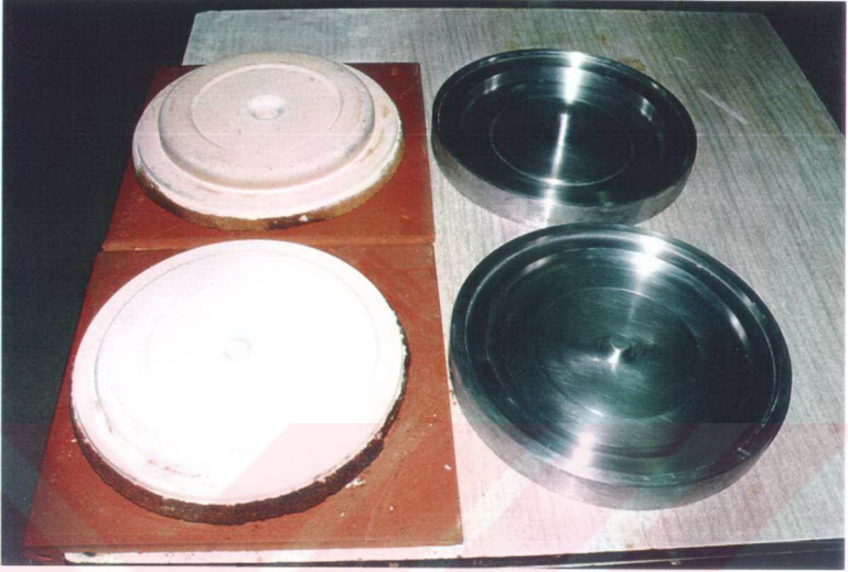
Şekil 4.8 Üst ve alt şov karma seramik kalıplar ve seramik kalıp modelleri
