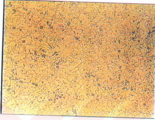
Şekil 7.5 T6 Isıl İşlemi Sonrası Matriks Alaşımının Mikroyapısı
