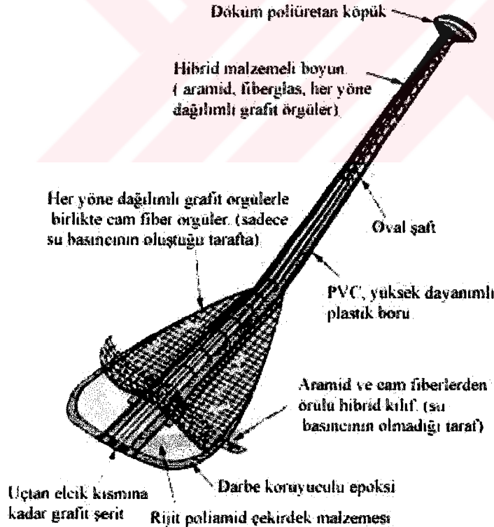
Şekil 6.1 Birçok kompozitin birleşiminden oluşan ultra-hafif bir kano küreği.
