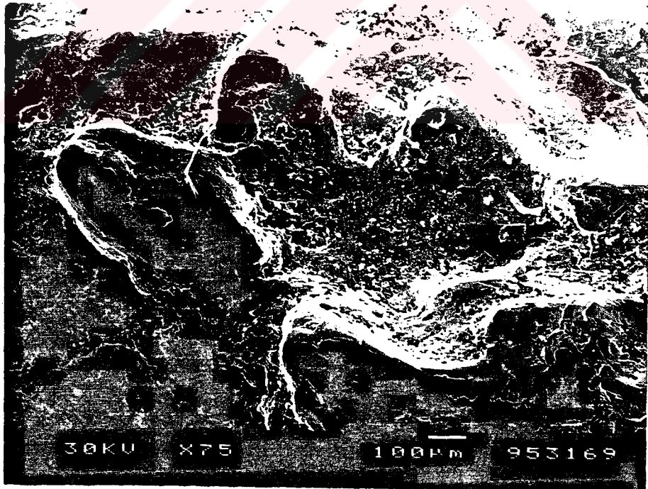
Şekil-4.77 Aynı numuneye ait farklı kırık yüzeyi sünek kırılma görünümündedir.
