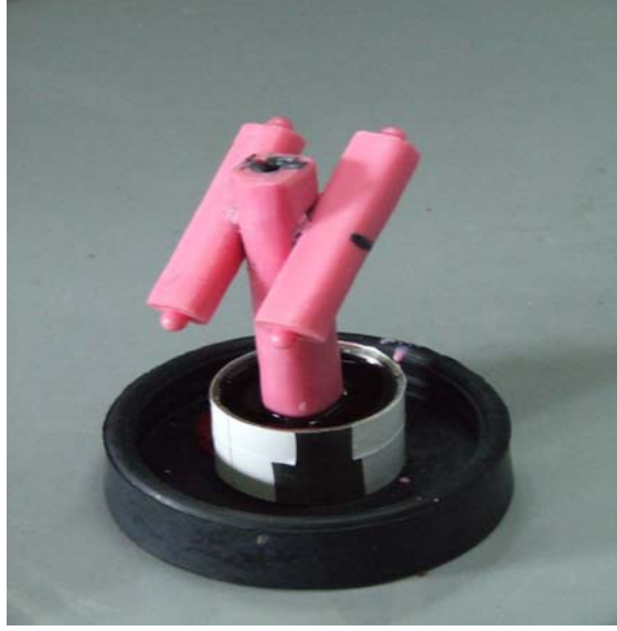
Şekil 5.4 Döküm parçalarda boyutsal değişimi ölçmek amacıyla kullanılan mum model ve döküm ağacı
