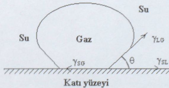
Şekil 2.5 \theta temas açısının oluşması (Yiğit ve Özkan, 2007).
