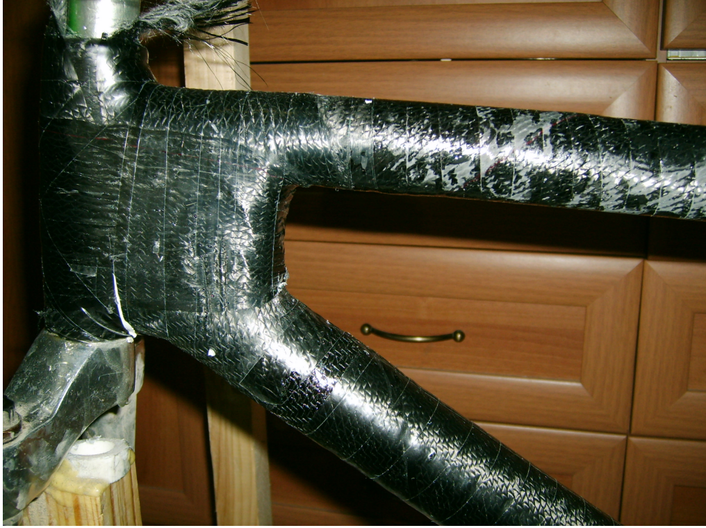
Şekil 4.28 Beşinci katmanlar sonrası ön tarafın görünümü
