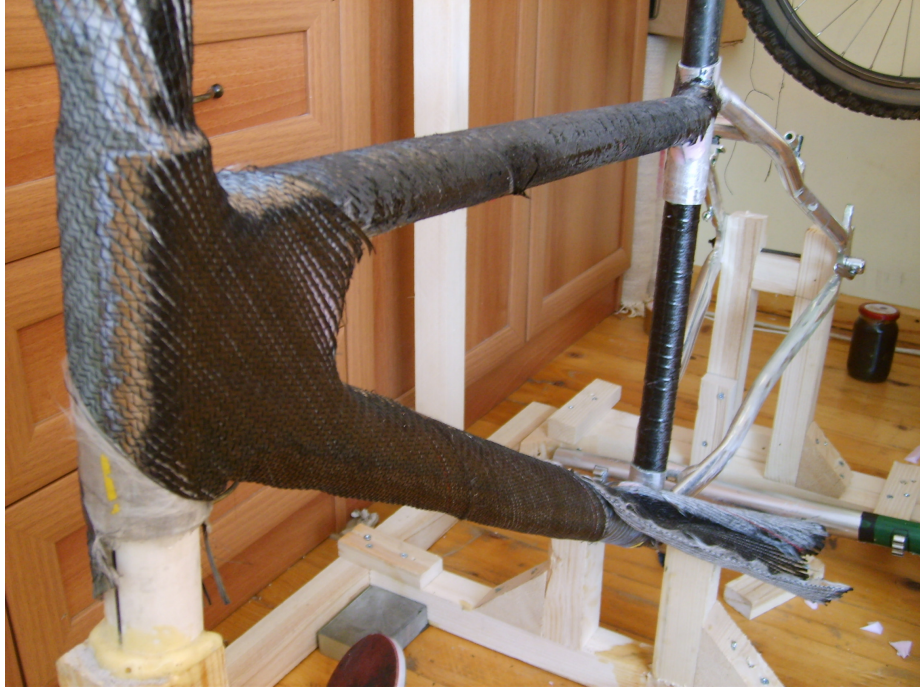
Şekil 4.21 İlk karbon fiber katmanı sarım öncesi alıştırılıyor.
