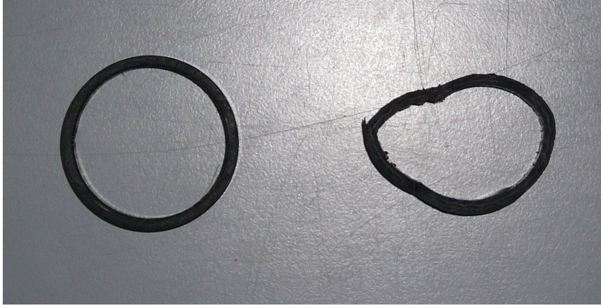
Şekil 4.54 Sağlam ve hasarlı halkaların görünümü
