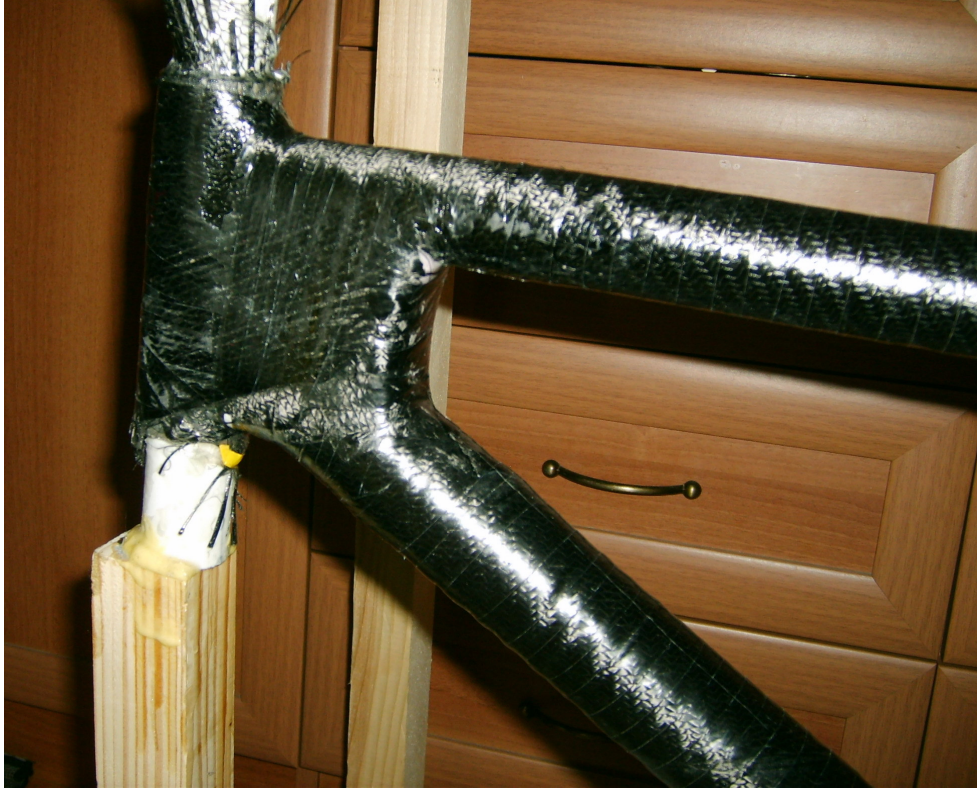
Şekil 4.24 Katılaşması tamamlanmış ilk katman. Sökülen PVC bantların izleri görülmekte.
