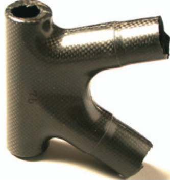
Şekil 3.5 Trek OCLV (Optimum Compaction Low Woid: Yüksek Sıkıştırma Düşük Boşluk) Karbon-kompozit alın rekoru (Lizotte, 1996)
