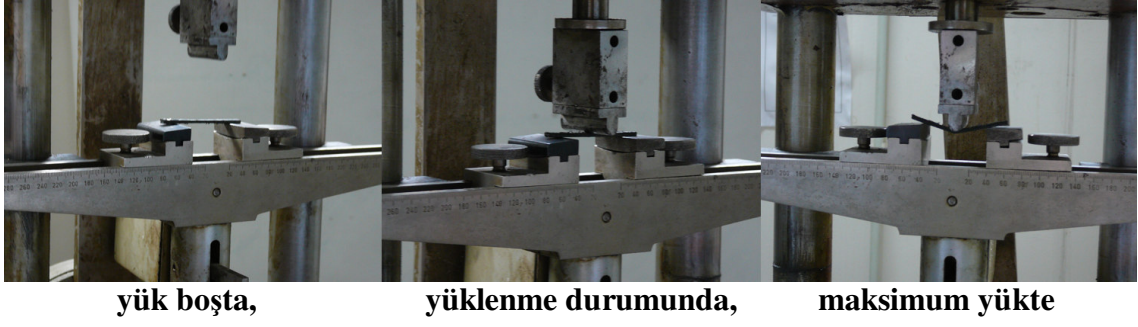
Şekil 4.48 Mikro Eğme Deneyi sırasında numunedeki değişim
