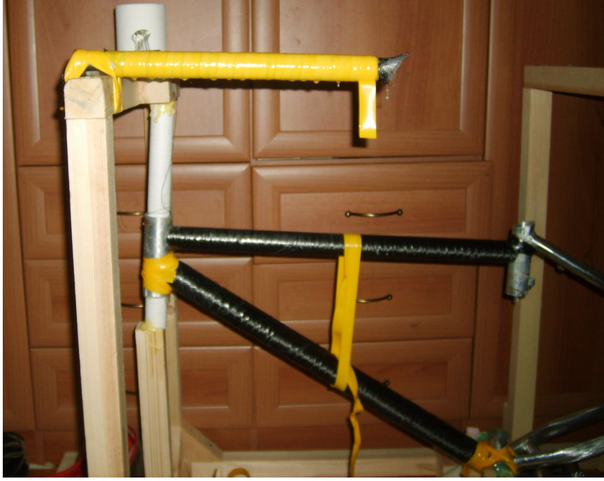
Şekil 4.15 Üst ve alt iç katman boruları monte edilmiş durumda, oturma borusu sarımı tamamlanmış kuruması bekleniyor.
