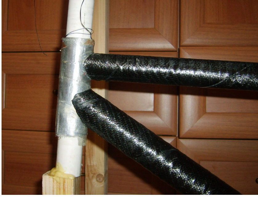
Şekil 4.16 Üst ve alt borular alüminyum borusu üzerinde kurt ağı birleşimi ile birbirlerine eklenmiş durumda.
