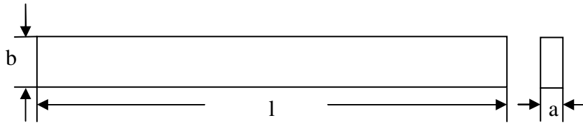
Şekil 4.65 Çekme deneyi numunelerinin boyutları
