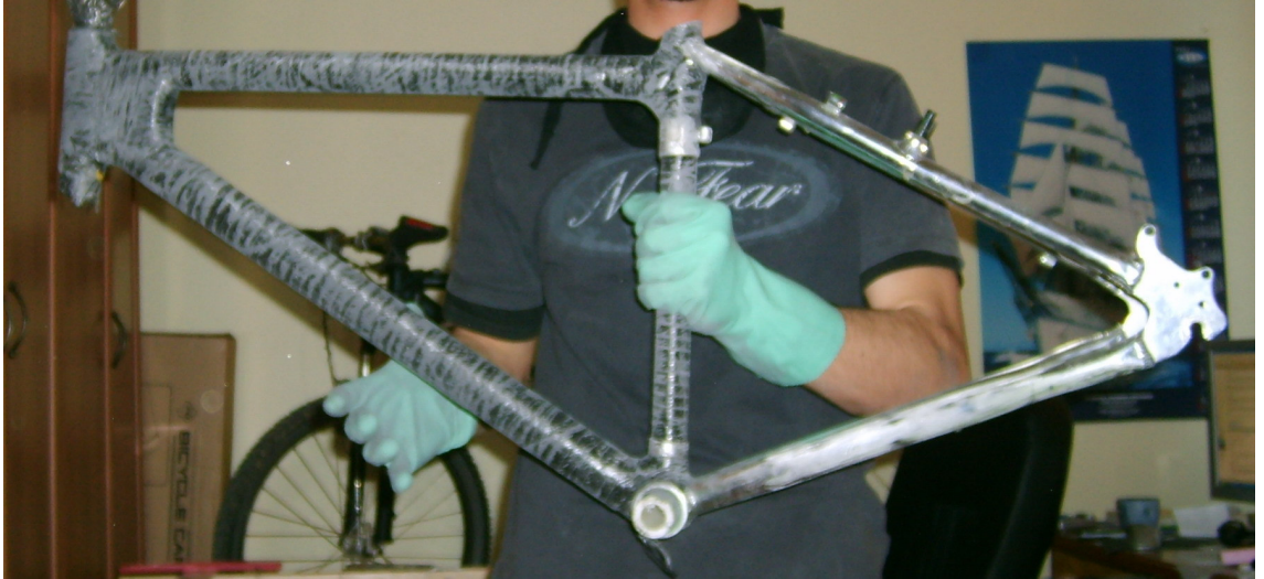
Şekil 4.23 Üst ve Alt boruların ilk katman sarımları tamamlanmış ve zımparalanmış
