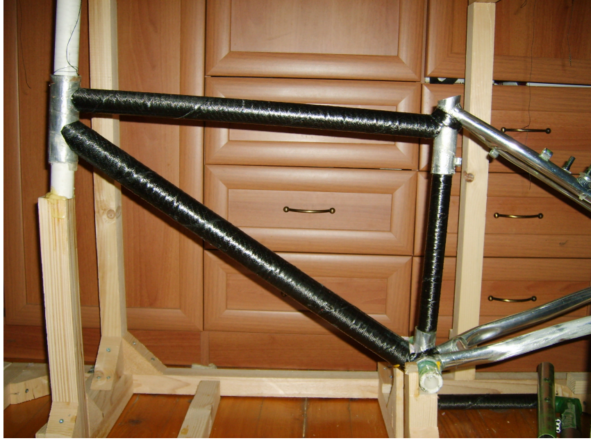
Şekil 4.18 Bütün iç borular tezgah üzerinde diğer alüminyum parçalar ile birleştirilmiş durumda
