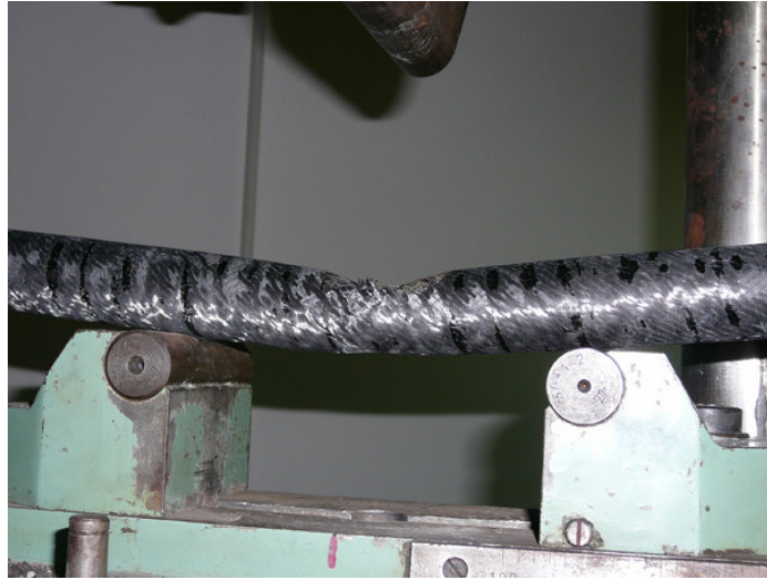
Şekil 4.61 Yük kaldırıldıktan sonra borunun görünümü
