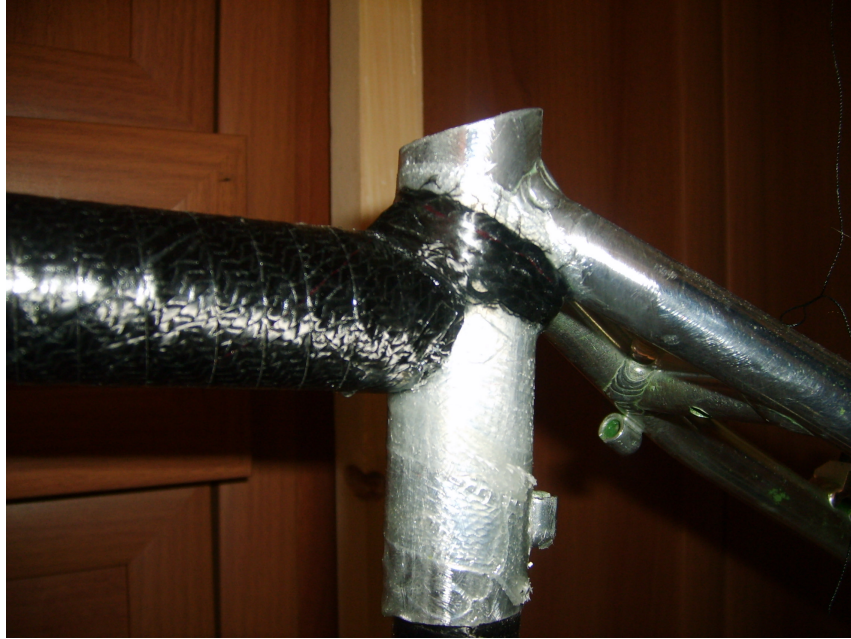
Şekil 4.17 Üst boru – oturma borusu birleşimi ve alüminyum-karbon-epoksi arayüzünde cam fiber kaplaması
