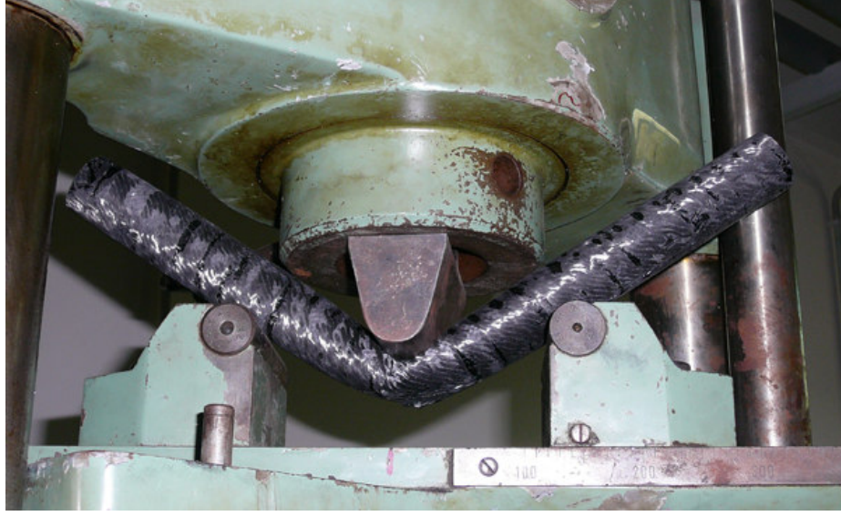
Şekil 4.60 Maksimum kuvvet altında borudaki eğilme
