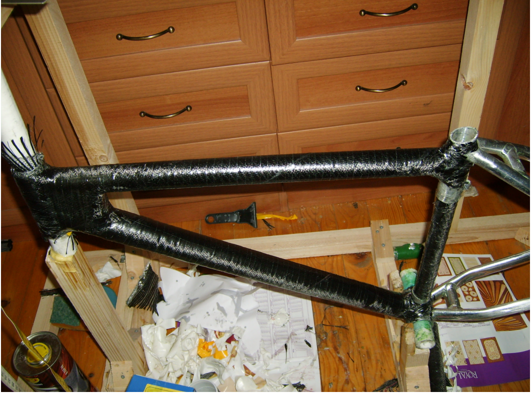
Şekil 4.26 İkinci katmanlar sonrası kadronun görünümü
