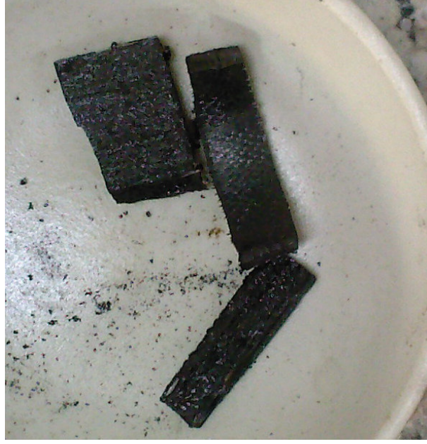
Şekil 4.40 Yakıldıktan ve epoksi içeriği uçurulduktan sonra numunelerin görünümü
