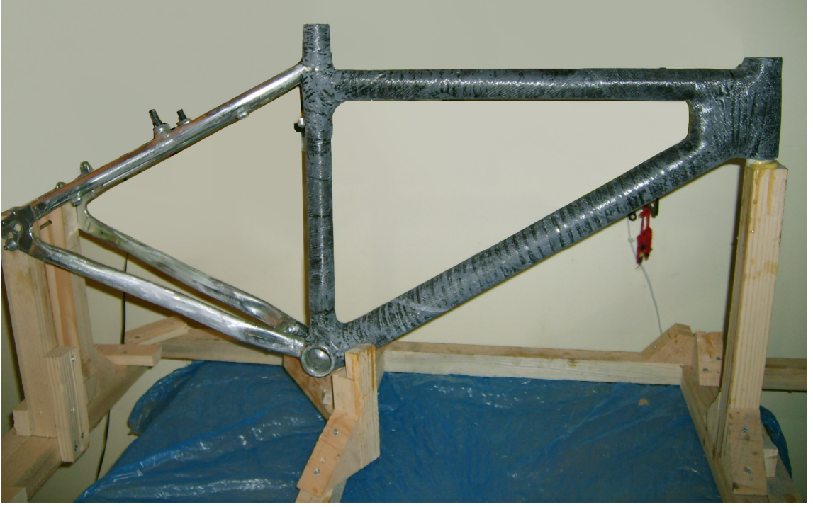
Şekil 4.30 Kadronun sarım işlemleri tamamlanmış ve zımparalanmış
