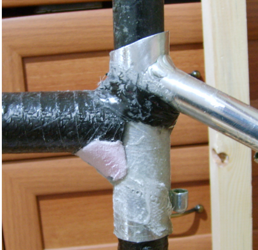
Şekil 4.20 Üst boru ve oturma borusu eki ve köpük dolgu.
