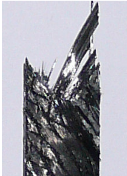
Şekil 4.70 Kopma yüzeyinin yakınlaştırılmış görünümü
