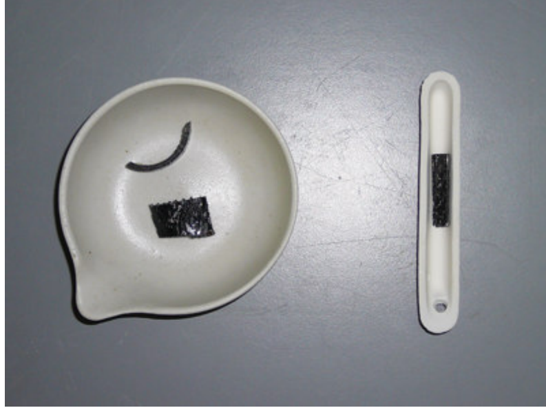
Şekil 4.37 Hacim oranı tayin edilecek olan numuneler ve seramik kayıkçıklar
