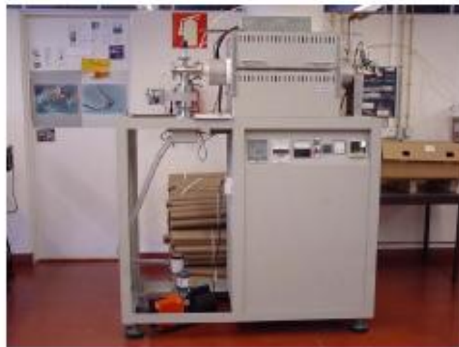
Sekil 4.5Isı l oksidasyon isleminin uygulandığı atmosfere acık fırın
