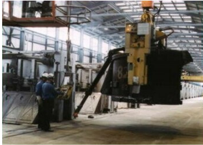
Şekil 4.12 Önceden pişmiş anotlu hücrelerden metal çekimi (Yalvaç, 2003)
