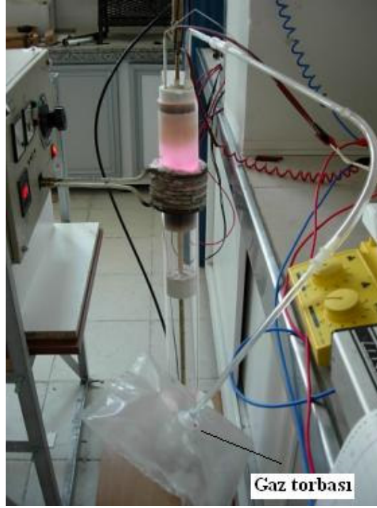
Şekil 7.16 Sistemden çıkan gazların gaz torbasında toplanması
