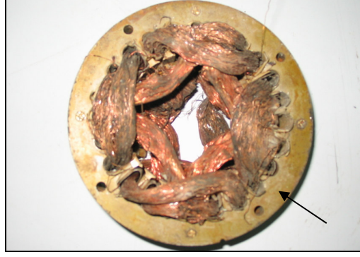
Şekil 4.1 Kullanım ömrünü tamamlamış hurda Si'li sac laminasyon tipinde istiflenmiş
