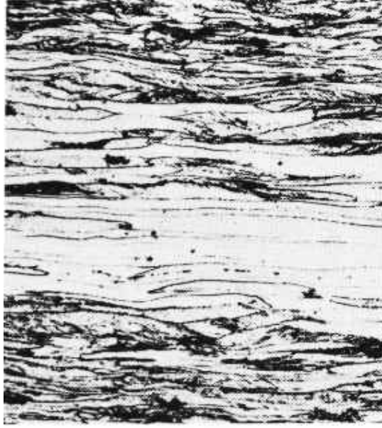
Şekil 4.25 %3 Si'li yassı haddelenmiş elektriksel sac (M22) %70 oranında 0.6 mm'ye indirilmiş.Yapı: ferrit taneleri haddeleme yönünde uzamış. %10 nital. X100(ASTM Hb., Vol.9).
