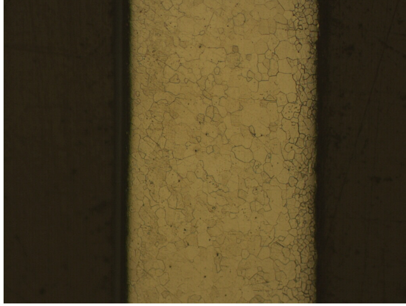
Şekil 4.45 Numune 3. Kullanım ömrünü tamamlamış %1,23 Si içeren çelik sacın kesitten alınan görüntüsü. Nital3x200
