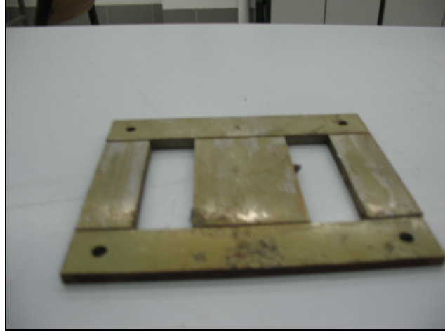
Şekil 4.4: EI tipi trafo sacı, tabaka halinde istiflenmiş
