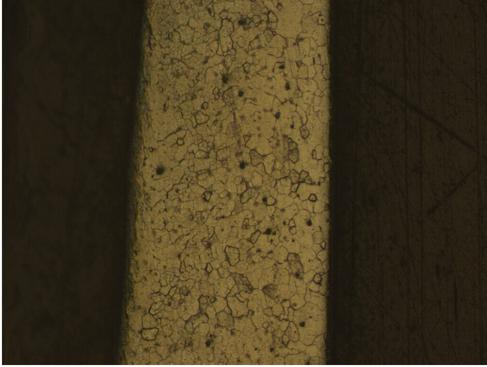
Şekil 4.47 Numune 4. Kullanım ömrünü tamamlamış %1,40 Si içeren çelik sacın kesitten alınan görüntüsü. Nital3x200
