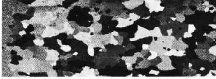
Şekil 4.35 %3Si'li çelik 0,35 mm kalınlığında. Kademeli olarak tavlanmıştır. 760 0 C'de 1 saat, daha sonra 1065 0 C'ye kadar her bir kademede 1 saat tavlanmıştır. Ve sıcak bir şekilde kuru hidrojen banyosunda 3 saat tutulmuş. İkinci tane kabalaşması yaklaşık 815 0 C'de başlamış. Tane büyüklüğü tipiktir. %20 HNO 3 , sonra %20 HCl (ASTM Hb., Vol.9).
