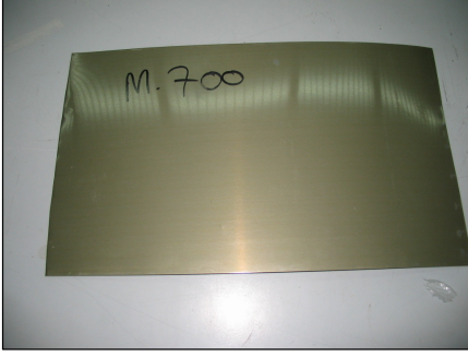
Şekil 4.5. Assan Alüminyum'dan alınan M700 ve M470 tipi orijinal silisli saclar
