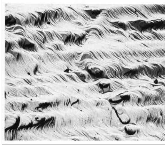
Şekil 4.41 %3 silisli tane-yönlendirilmiş çelikte termal yönlendirilmiş veya oyuklanmış ferrit tabakaları, 0,3'ten 0,1 kalınlığına soğuk haddelenmiş ve 3 saat kuru hidrojen atmosferinde 1205^{\circ}\text{C} 'de tavlansmıştır. Hidrojende termal dağlama 1205^{\circ}\text{C} 'de (ASTM Hb., Vol.9).
