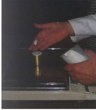
Şekil 8.1 Akışkanlık testinde kullanılan halka ve karışımın dökümü.
