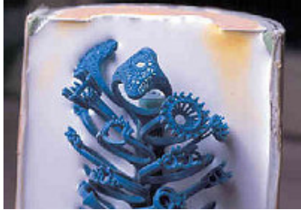
Şekil 5.5 Hazırlanmış bir kalıbın mum alınmadan önceki kesit görüntüsü [2]
