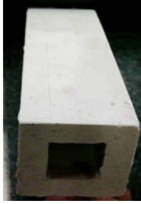
Şekil 8.3 Deney numunelerinin dökölldüğü silikon kalıp.
