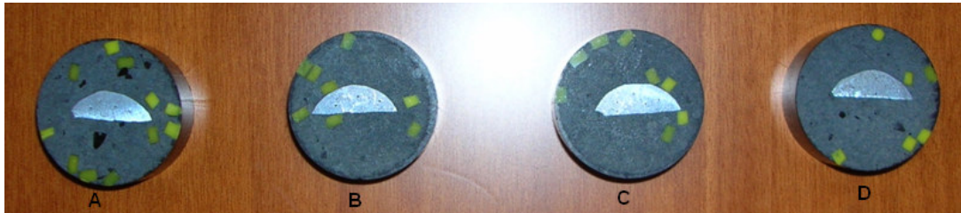
Şekil 5.13 75\text{ }\mu\text{m} çaplı partikül takviyeli numuneler.
