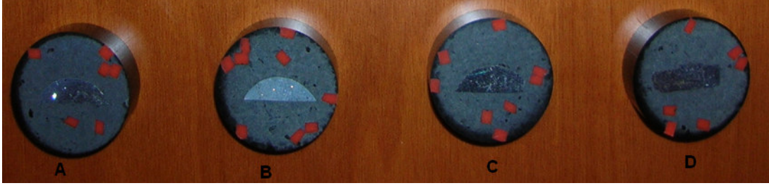
Şekil 5.14 100 \mu\text{m} çaplı partikül takviyeli numuneler.
