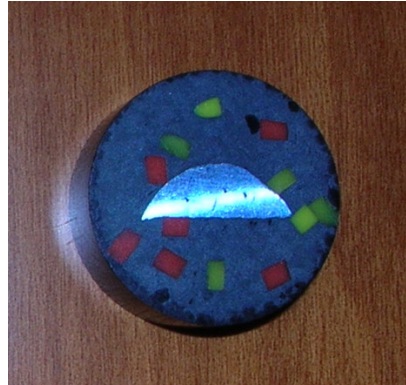
řekil 5.17 Daėlama sonrası yzeyi incelemeye hazır bir numune.
