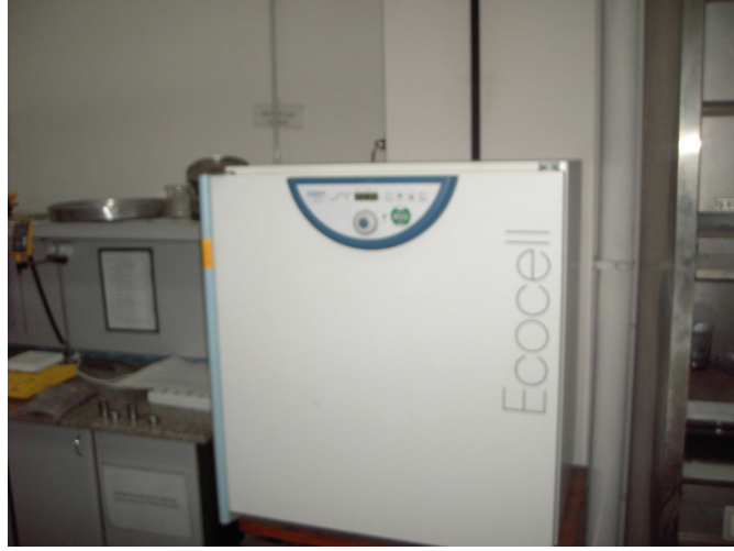
Şekil 8.2 Numunelerin kurutulmasında kullanılan Etüv
