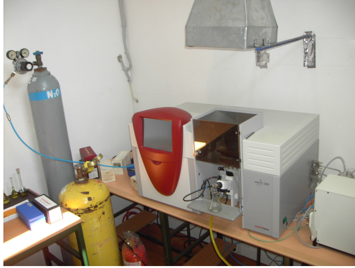
Şekil 8.4 Analiz işlemlerinde kullanılan Atomik Absorbsiyon cihazı
