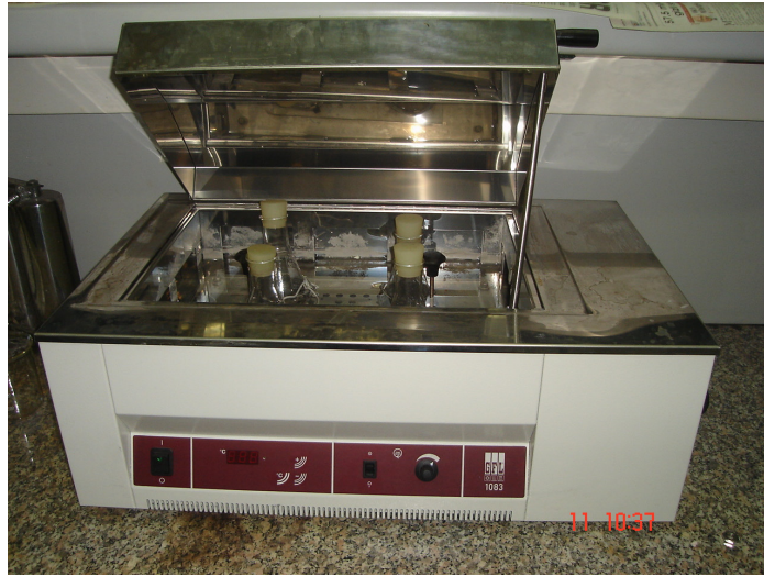
Şekil 8.3 Liç işlemlerinde kullanılan su banyosu
