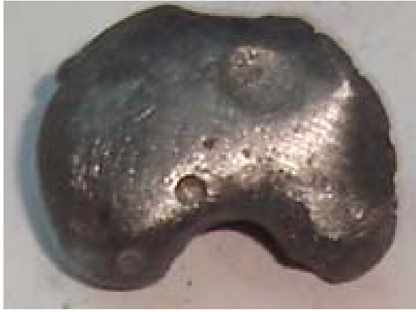
c) 3 no.lu numuneden üretilen demir tanesinin görünümü.
