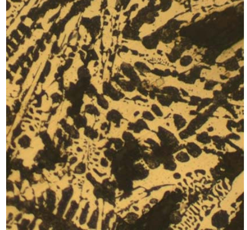
d) 3 no.lu numuneden üretilen demir tanesinin mikroyapısı. (x500)
