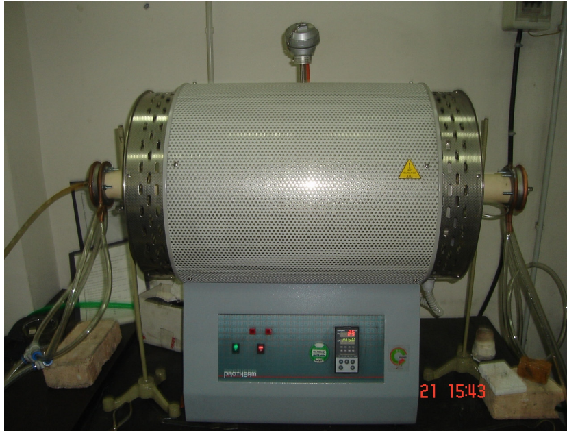
Şekil 7.2 Redüksiyon için kullanılan yatay tüp fırın.
