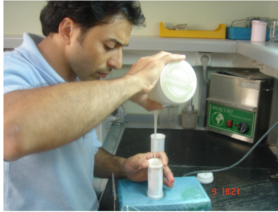
Şekil 6.28 Manşet içindeki modelin üzerine Empress dökülerek kalıplanması.
