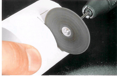
Şekil 6.36 Ayırma diski ile ingotun kesilmesi a)1.kademe, b) 2. kademe.
