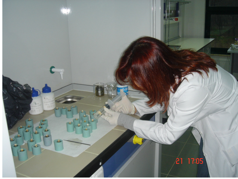
Şekil 6.3 Dişlerin epoksi ile kalıplanması.
