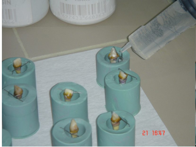
Şekil 6.4 Epoksi reçinenin silikon kalıplara dökülmesi.
