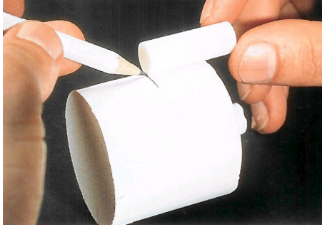
Şekil 6.35 Kalıbın üzerindeki pistonun uzunluğunun ölçülmesi.
