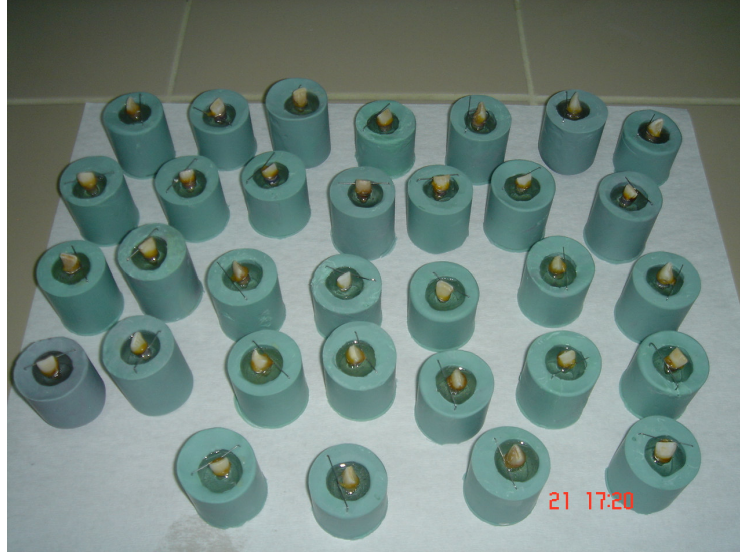
Şekil 6.5 Epoksi ile kalıplanmış diş numuneleri.
