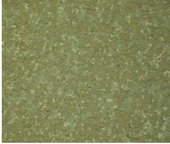
Şekil 13.2 Sinterleme sonrası SB30 tozlarının mikro yapısı
