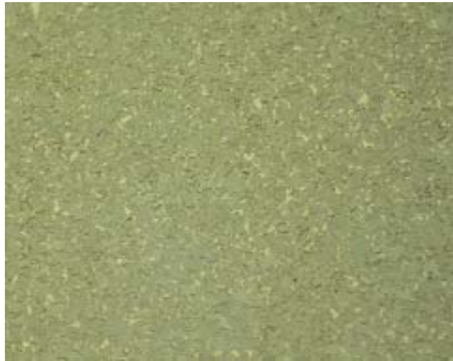
Şekil 13.5 Sinterleme sonrası HB10 tozlarının mikro yapısı
