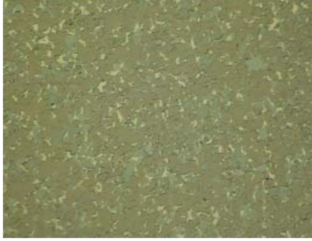
Şekil 13.4 Sinterleme sonrası HB20 tozlarının mikro yapısı
