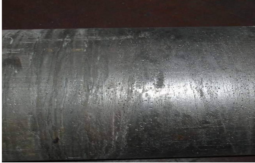
Şekil 3.6 Hatalı gömlek (gaz boşluğu + kat oluşumu).
