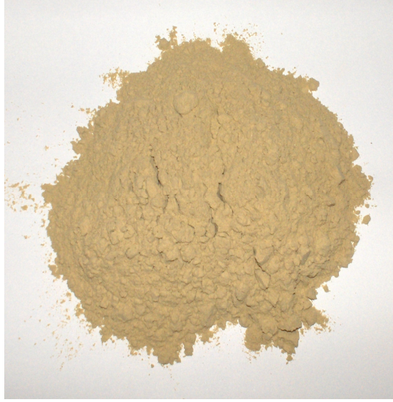
Şekil 4.10 Kaplama yapımında kullanılan bentonit malzemesi
