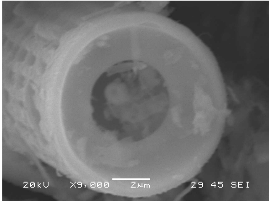
Şekil 4.15 Diatomit tozu SEM görüntüsü
