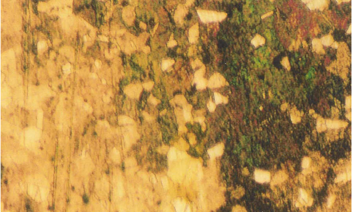
Şekil 6.9 700 °C’de 20 dk tavlama
