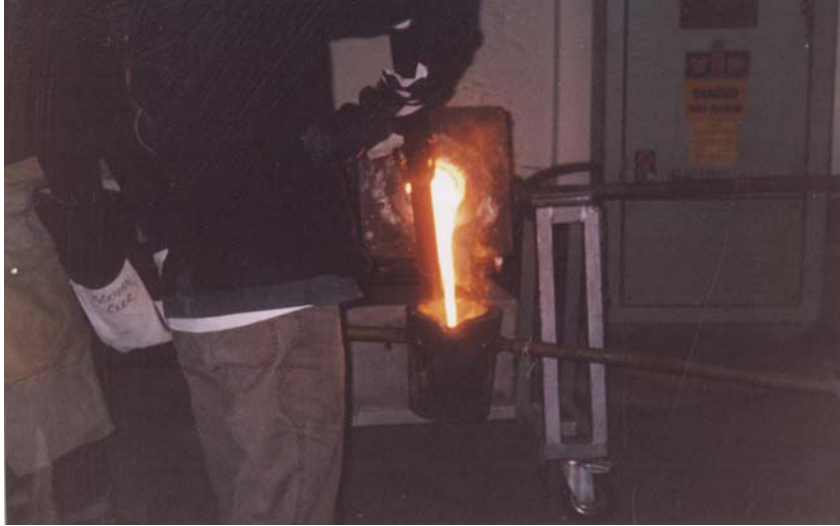
Şekil 11.23 Eriyik metale aşılama işlemi
