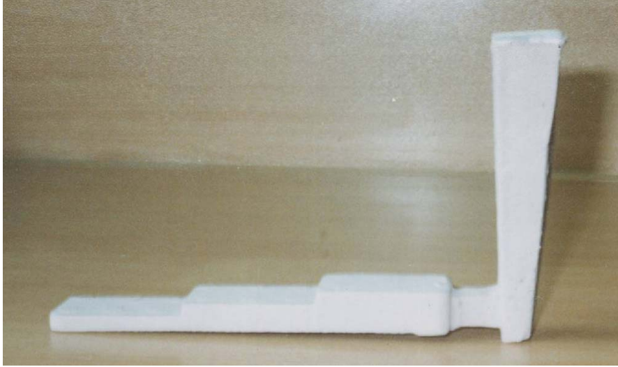
Şekil 11.20 Refrakterle kaplanmış kalıplamaya hazır polistiren modeller
