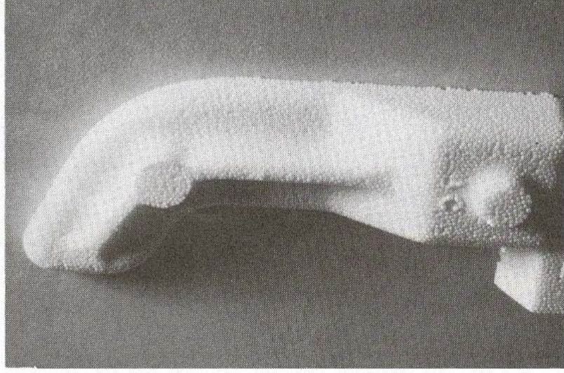
Şekil 6.2 Soğuk kalıptan kaynaklanan düşük yüzey kalitesi (Monroe , 1992)
