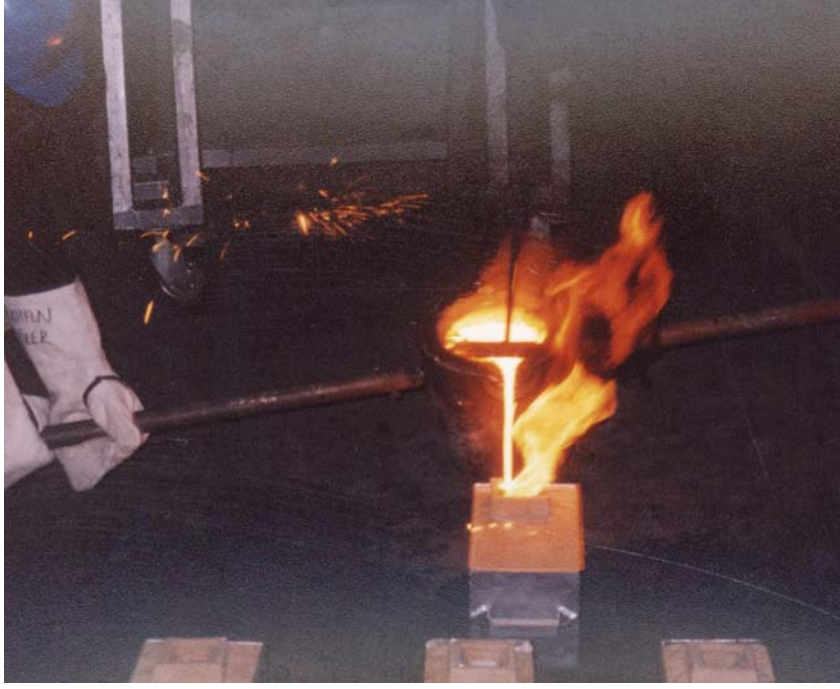
Şekil 11.24 Küresel grafitli dökme demirin döküm anı
