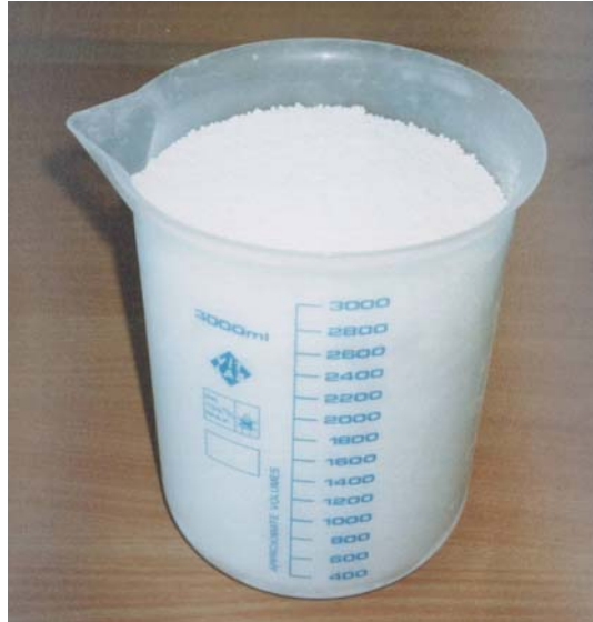
Şekil 11.14 3 bar basınçta 45 saniye önşişirilmiş polistiren taneleri
