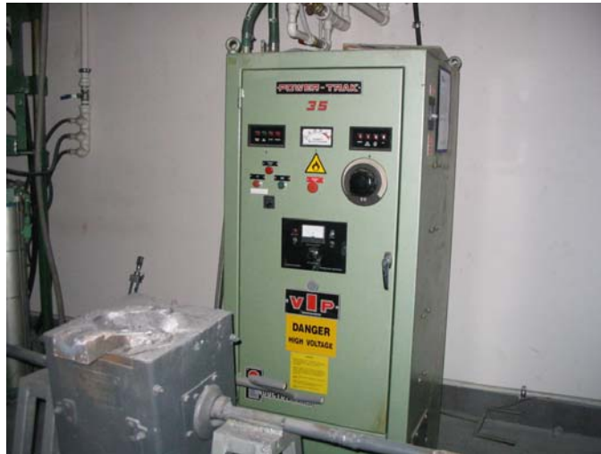
Şekil 11.13 Dökme Demir dökümlerinde kullanılan ergitme ocağı
