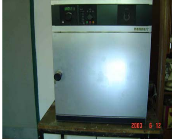
Şekil 11.10 Önşişirilmiş polistiren boncuklarının kararlaştırılması sırasında ve polistiren modellerin yüzeyindeki refrakterin kurutulması işleminde kullanılan etüv
