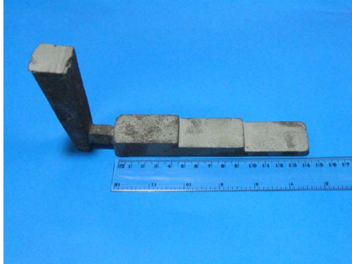
Şekil 11.25 Dolu kalıba döküm yöntemiyle üretilen küresel grafitli dökme demir
