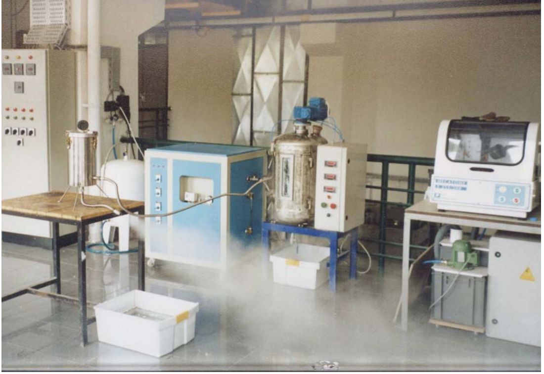
Şekil 11.15 Polistiren model üretimi
