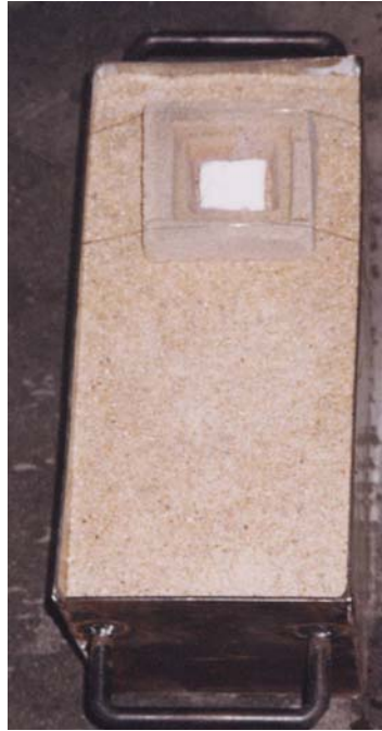
Şekil 11.21 Döküme hazır derece içerisine yerleştirilmiş polistiren modeli
