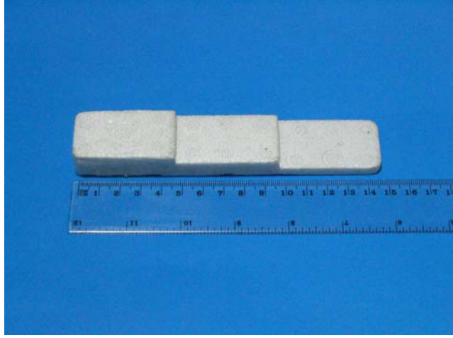
Şekil 11.17 1 bar basınçta 70 saniye şişirilmiş polistiren modeli
