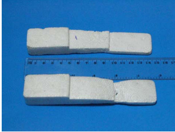
Şekil 11.16 1.5 bar basınçta 80 – 90 saniye şişirilmiş polistiren modelleri
