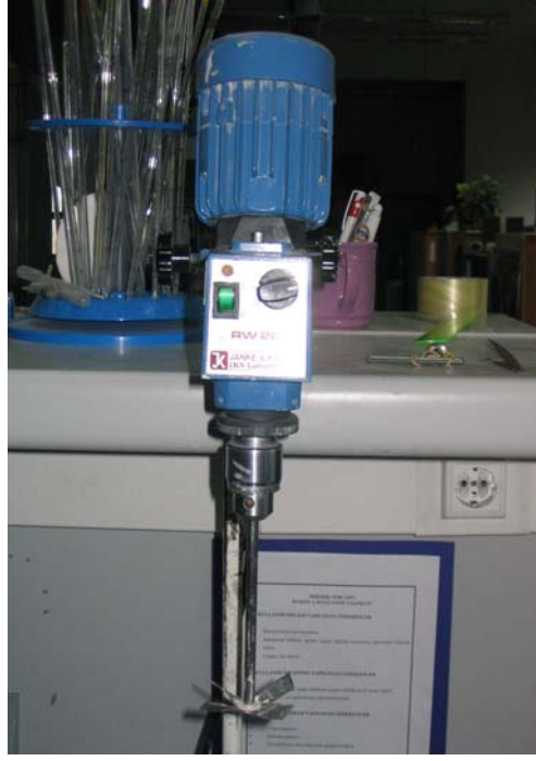
Şekil 11.8 Refrakter çamurunun su ile karıştırılması için kullanılan karıştırıcı
