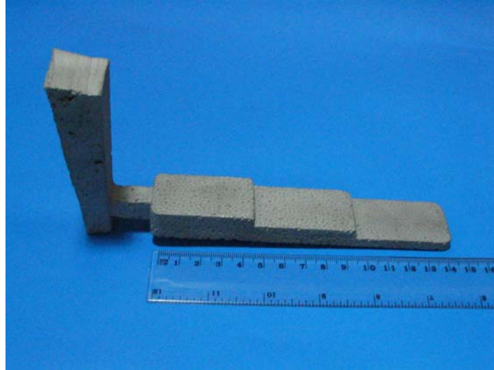
Şekil 11.22 Dolu kalıba döküm yöntemiyle elde edilmiş alüminyum parça
