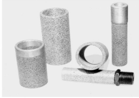
Şekil 3.12 Alüminyum köpükten yapılmış susturucular (Banhart, 2000b).
