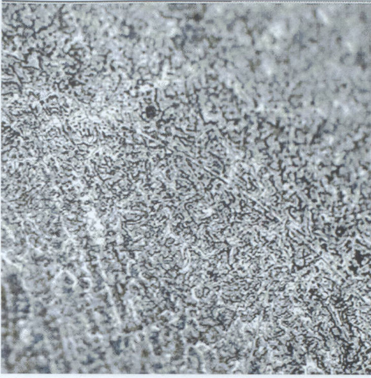
Şekil 5.63 4.EA.2 no.lu numunenin kaynak bölgesi (400X)
