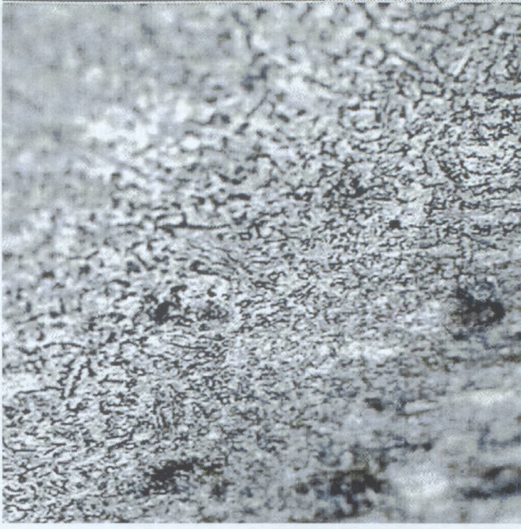
Şekil 5.69 4.TIG.2 no.lu numunenin kaynak bölgesi (400X)
