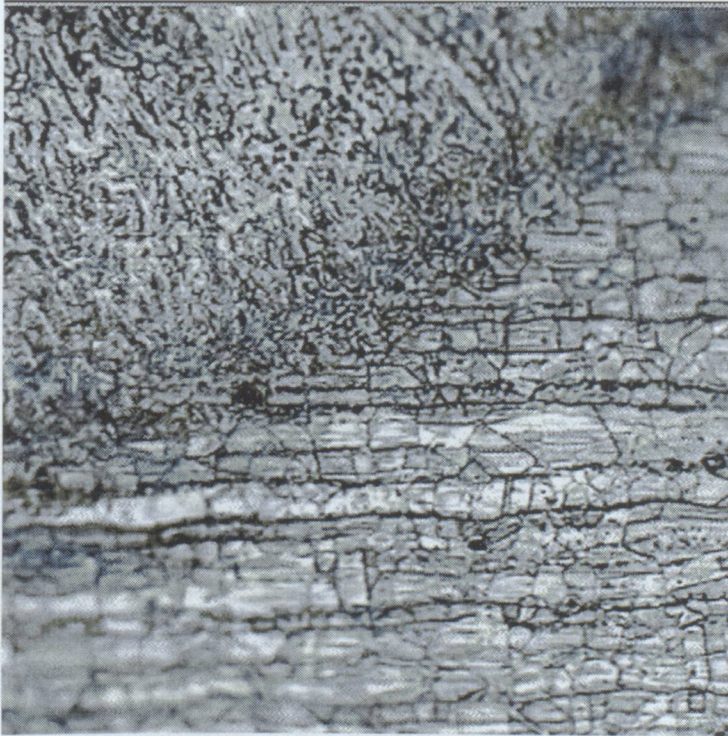
Şekil 5.64 4.EA.2 no.lu numunenin kaynak dikişi ve ITAB (400X)
