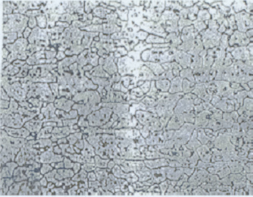
Şekil 3.7 446 tipi ferritik paslanmaz çeliğin 802°C’de tavlandıktan sonra HCl+Metanol ile dağlanmış mikroyapısı. Yapı eştaneli ferrit matriste dağılmış karbür parçacıklarından oluşmuştur.
