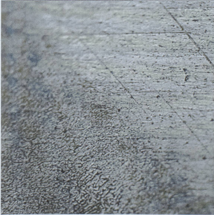
Şekil 5.70 4.TIG.2 no.lu numuneye ait kaynak dikişi ve ITAB (400X)
