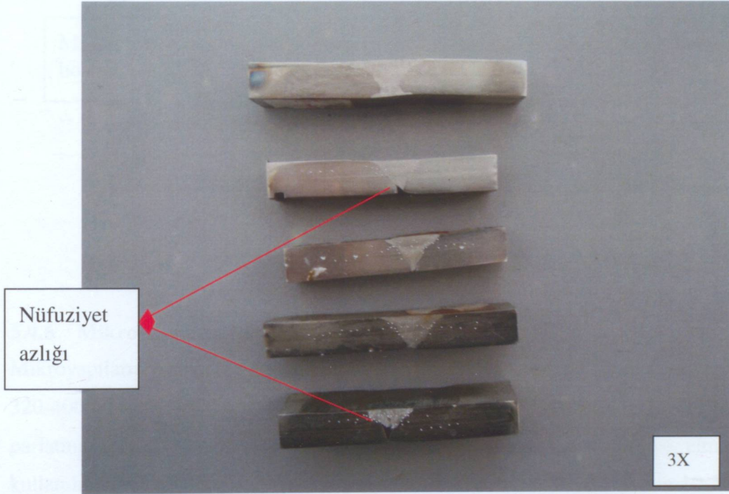
Şekil 5.29 316L numunelere ait makro yapı görüntüleri
