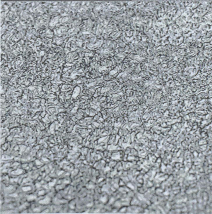
Şekil 5.56 3.TIG.1 no.lu numunenin kaynak bölgesi (400X)
