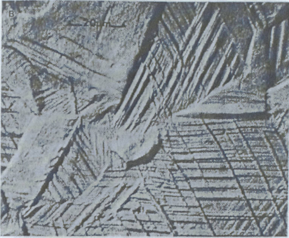
Şekil 3.24b) Soğuk şekillendirilmiş 316L paslanmaz çelik bel kemiği çubuğunun tanelerinin ayrıntılı resminde plastik deformasyon olduğu görülmekte. (classes of materials used in medicine)
