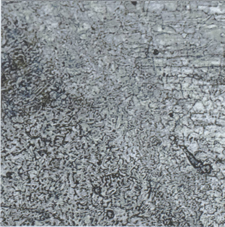
Şekil 5.66 4.EA.3 no.lu numuneye ait kaynak dikişi ve ITAB (400X)
