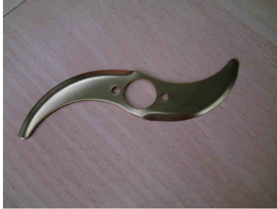
Şekil 3.2 AFS Bıçak tarafından TiN kaplaması yapılmış bir doğrayıcı (blender) bıçağı.
