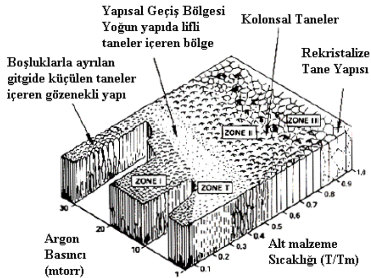
Şekil 6.5 Thornton yapısal bölge modeli.[1]
