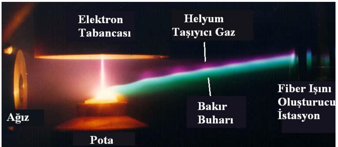
Şekil 5.16 İyon kaplama tekniğine ait bir uygulama örneği.[4]
