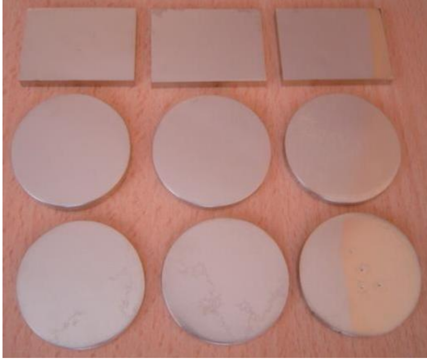
Şekil 8.7 V_{bias}=-150V kullanılarak Zr/ZrN biriktirilen numunelerin toplu fotoğrafı.
