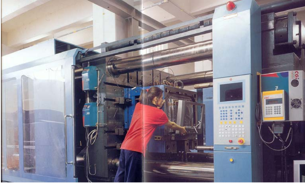
Resim 5.2 : 1200 tonluk gaz enjeksiyonu teknolojisine sahip Jon Wai enjeksiyon makinesi
