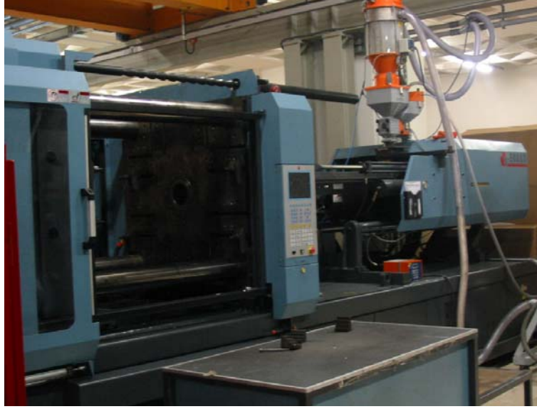
Resim 5.1: 500 ton mengene kapama gücüne sahip Jon Wai marka enjeksiyon makinesi
