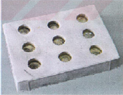
Şekil 9.5 Numunelerin şekillendirilmesinde kullanılan silikon kalıp
