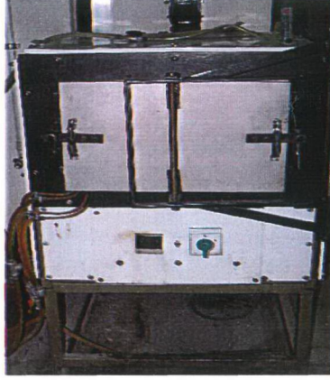
Şekil 9.2 Piroliz işlemi için kullanılan max 1200 °C' lik atmosfer kontrollü fırın
