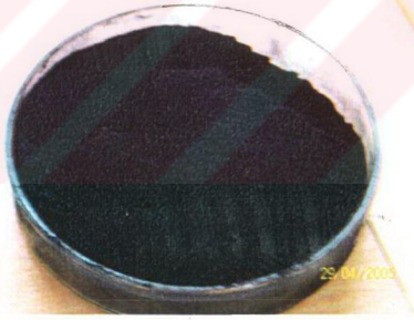
Şekil 10.5 Alümina bilyalı değirmende 48 saat öğütülen P.P.K
