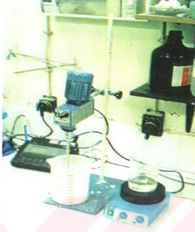
Şekil 9.4 PPK Tozu ve bağlayıcının karıştırılmasında kullanılan mekanik ve manyetik karıştırıcılar
