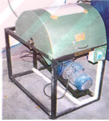
Şekil 9.3 Öğütme için kullanılan bilyalı değirmen
