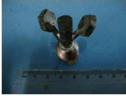
Şekil 5. 22 Paslanmaz çelik döküm ağacı örneği
