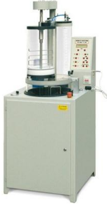
Şekil 5. 10 Goldaş A.Ş. dökümhanesinde kullanılan otomatik vakumlu karıştırıcı
