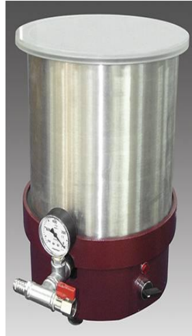
Şekil 5. 9 Üniversite döküm laboratuvarında kullanılan vakum kabini
