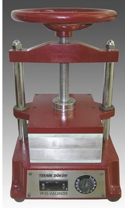
Şekil 5. 2 Kauçuk kalıp presi
