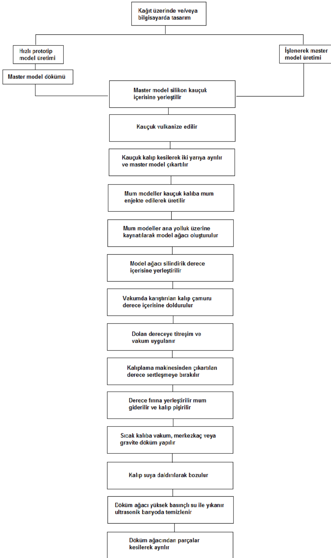
Şekil 2. 5 Tüm işlemleriyle dereceli hassas döküm akım şeması
