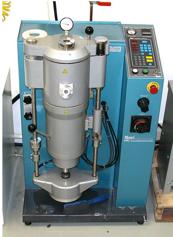
Şekil 5. 18 Basınçlı vakum döküm makinesi
