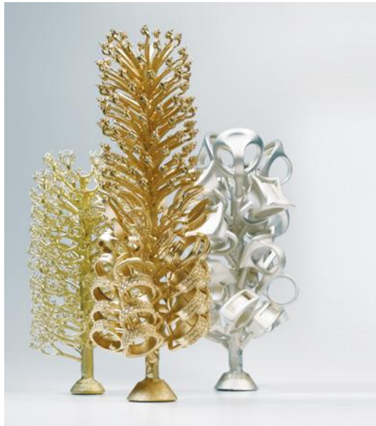
Şekil 2. 9 Dereceli hassas döküm takı döküm ağaçları [20]
