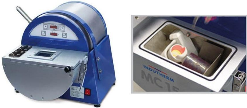
Şekil 5. 21 Vakum indüksiyon mikro döküm makinesi
