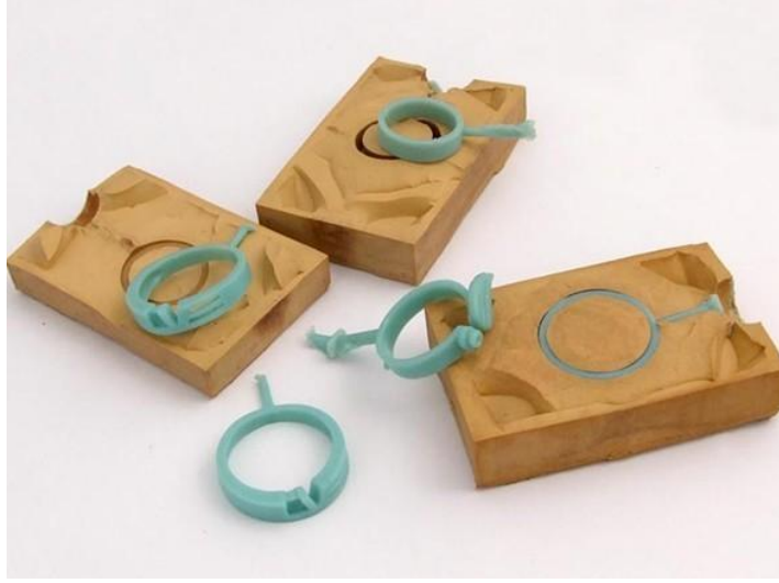
Şekil 2. 6 Kauçuk kalıplar ve mum modeller [16]
