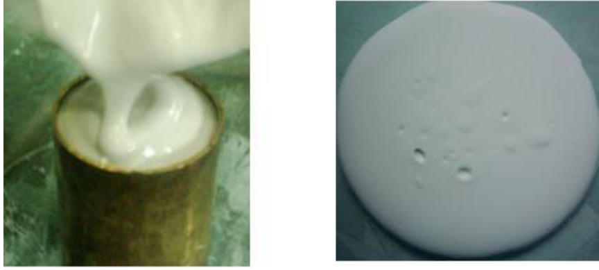
Şekil 5. 28 Karışımın halkaya doldurulması ve çapı ölçülecek bir numune
