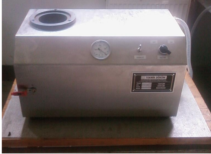
Şekil 5. 14 Vakum destekli döküm makinesi
