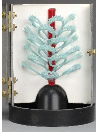
Şekil 3. 1 Dereceli hassas döküm kalıbı kesiti [21]
