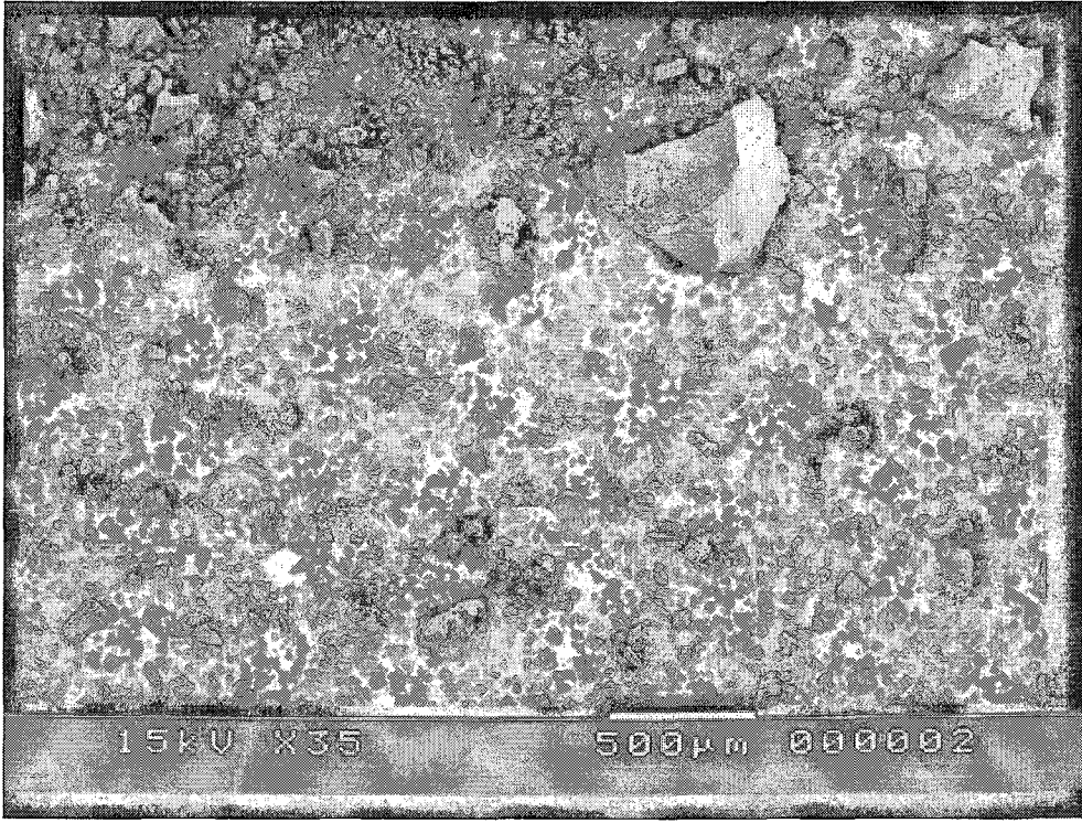
Şekil 7.10 Ultrasonik karıştırma ile elde edilen kurşun-zirkonat-titanat tozlarına ait 35 büyütmede çekilen SEM fotoğrafı
