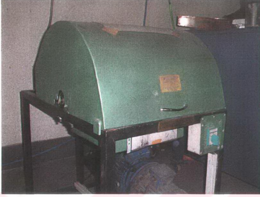
Şekil 3.3 Silisyum karbür tozlarının hazırlandığı alümina bilyalı değirmen.
