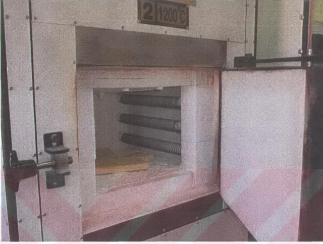
Şekil 3.5 Maksimum 1200 °C de çalışabilen sinterleme fırını
