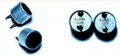
Şekil.4.2 Ultrasonik uzaklık ölçümünde kullanılabilecek 40KHz'lik alıcı ve verici sensör çiftleri
