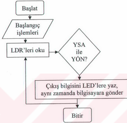
Şekil 3.13 Mikrodenetleyici yazılımının akış diyagramı
