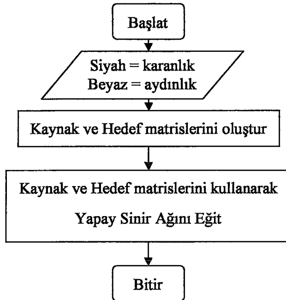
Şekil 2.1 Sadece resim içeren Learn_bw.m programına ait algoritma
