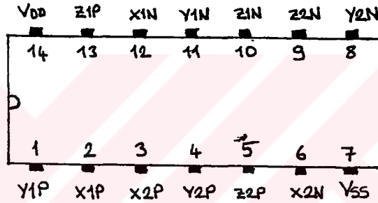
Şekil 7.1. Devrenin bacak bağlantıları
