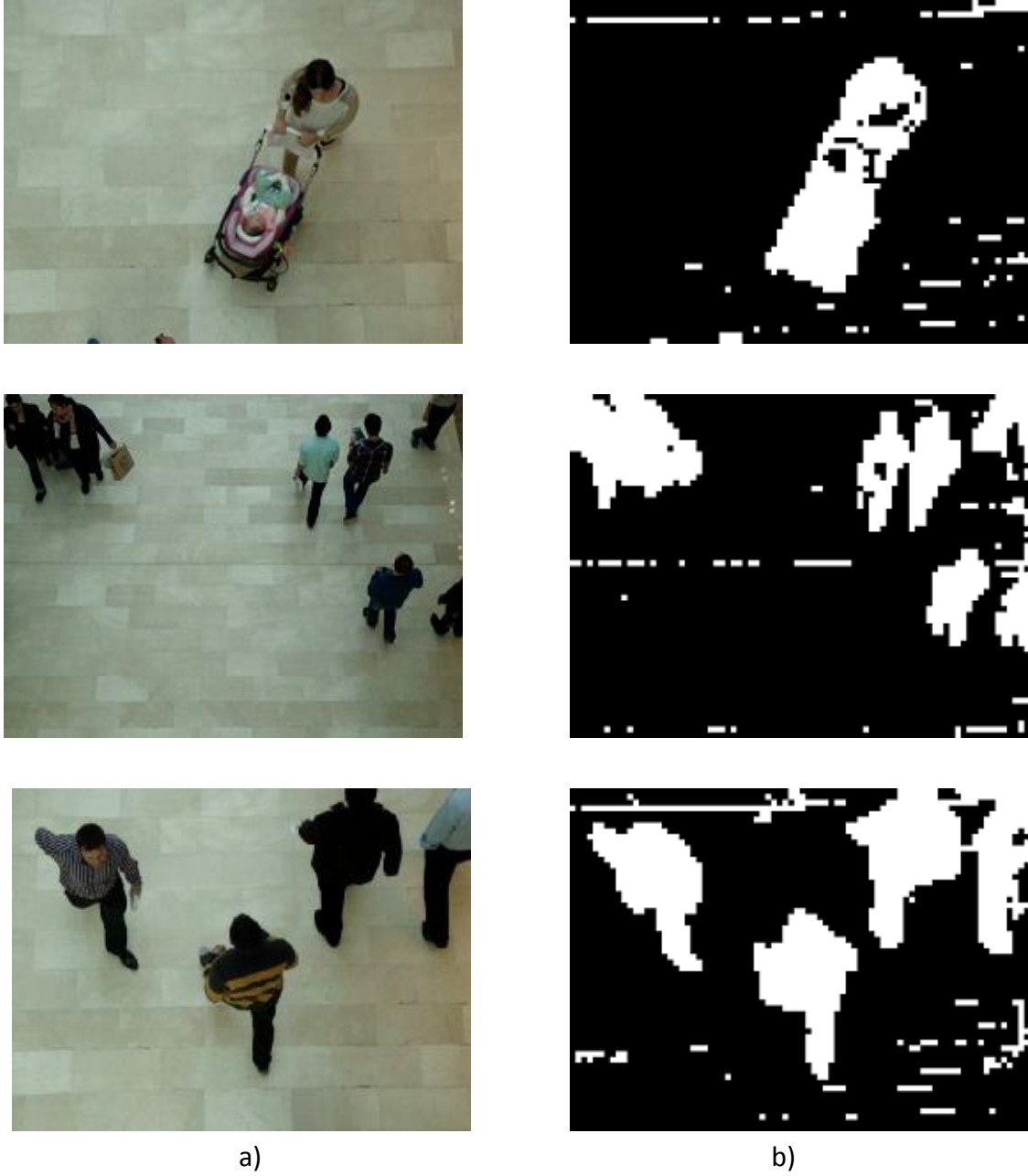
Şekil 3.6 Zorlayıcı bazı durumlar için blok tabanlı arka plan çıkarma sonucu a) orijinal kare b) blok tabanlı arka plan çıkarma sonucu
