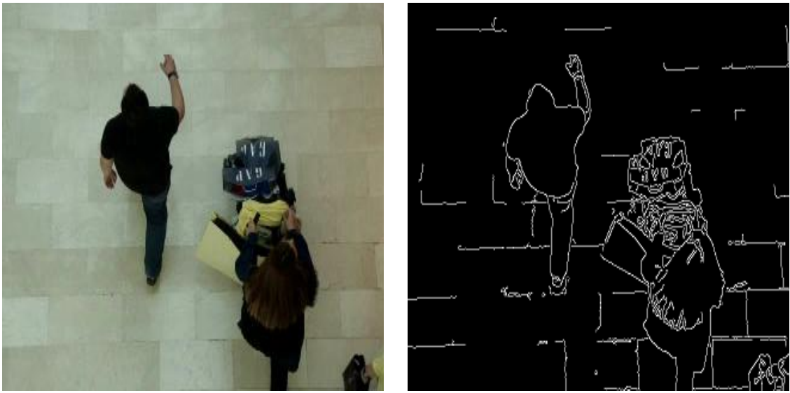
Şekil 2.7 Canny kenar bulma algoritması sonucu
