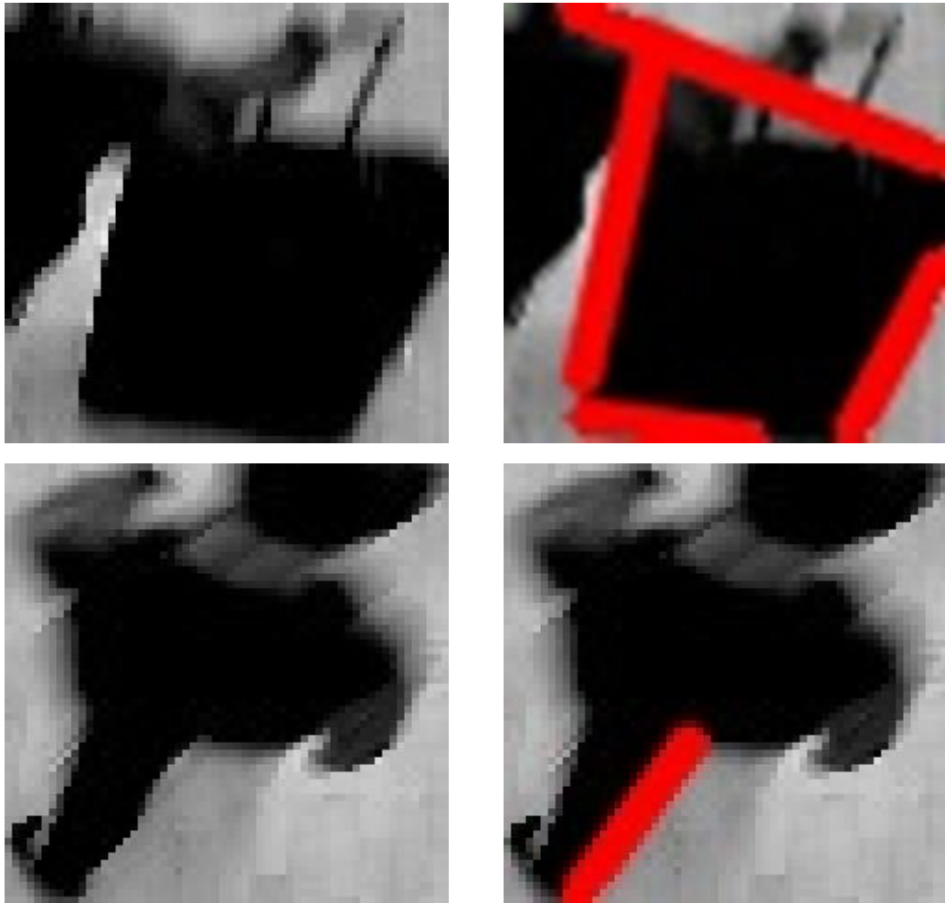
Şekil 3.13 Valiz ve insan geçişi sırasında Hough dönüşümü ile tespit edilen doğrular
