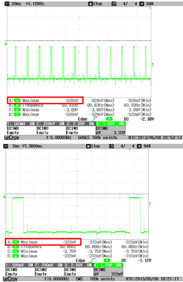
Şekil 2.14 Normal durumda (altta) ve tüm LED’ler aktif (üstte) iken V_{CE} ölçümü
