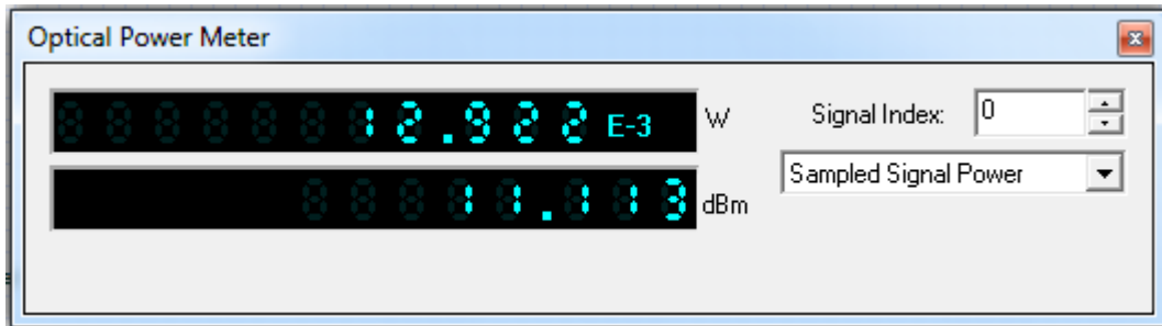
Şekil 7.6 Hibrid fiber kuvvetlendirici çıkışındaki işaretin gücü
