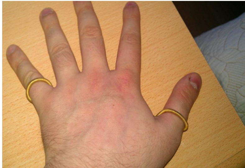
Şekil 4.4 Yüzük elektrotlarının kullanımı
