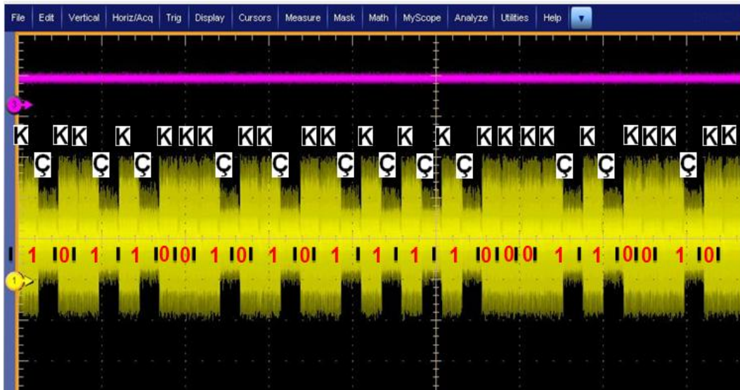
Şekil 3.4 RSA algoritmasında anahtara göre farklı güç tüketiminin oluşması
