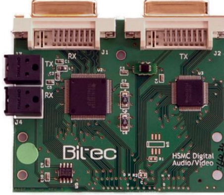
Şekil 5. 7 Bitec DVI Yardımcı Kart
