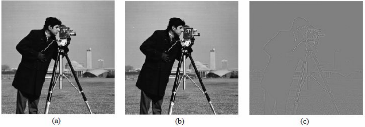
Şekil 6. 4 (a) Giriş görüntüsü (b) Gri tonlamalı görüntü (c) Laplacien ile konvolüsyon sonucunda elde edilen görüntü
