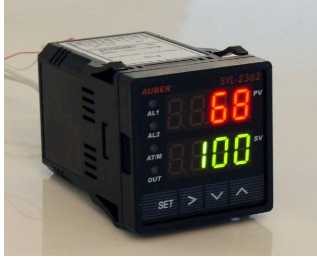
Şekil 1.31 Auber Instruments SYL-2362 cihazı [9]
