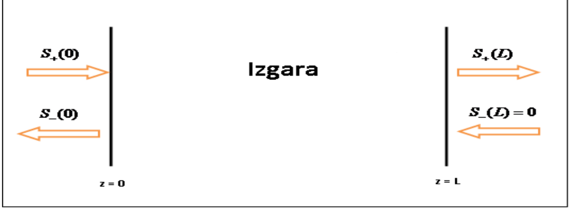
Şekil 4.8 Sonlu uzunluklu Bragg ızgarada yansıyan ve iletilen alanlar.
