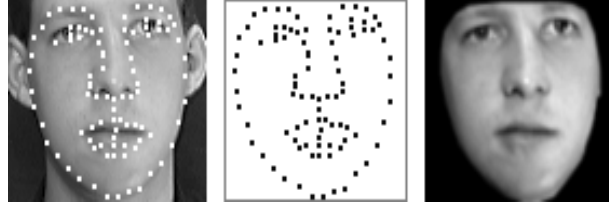
Şekil 2.10 Yer imleri yerleştirilip elde edilen AAM model parametreleriyle yeniden sentezlenen görüntü
