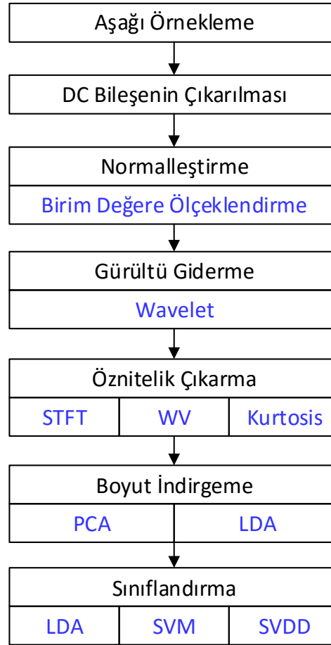
Şekil 5. 1 Sinyal işleme aşamaları ve yöntemler
