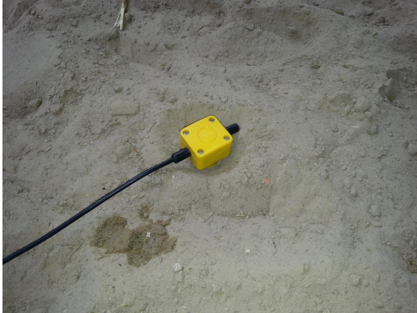
Şekil 5. 3 Jeofonun kum zemine gömülmesi
