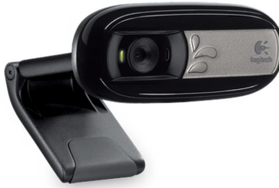
Şekil 4. 6 Tez çalışmasında kullanılan Logitech C170 model web kamerası [61]
