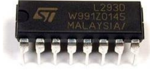
Şekil 4. 5 L293D motor sürücü entegresi
