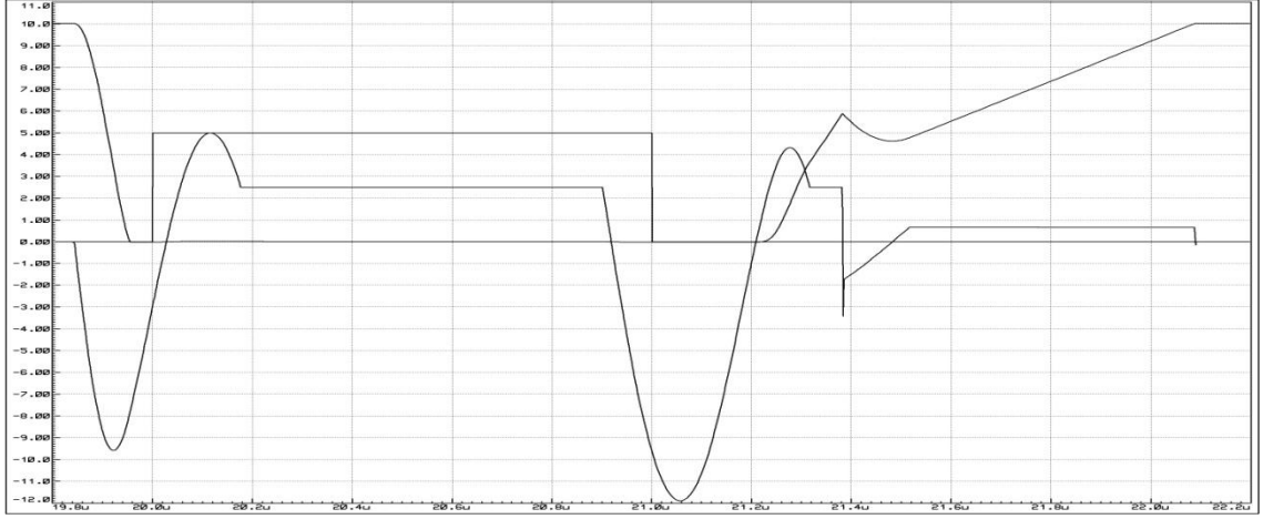
Şekil 4.4 Ana anahtarın S_1 'in akımı, gerilimi ve iletim sinyali
