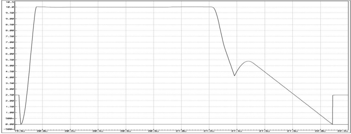
Şekil 4.5 Ana diyot D_f 'nin akımı ve gerilimi
